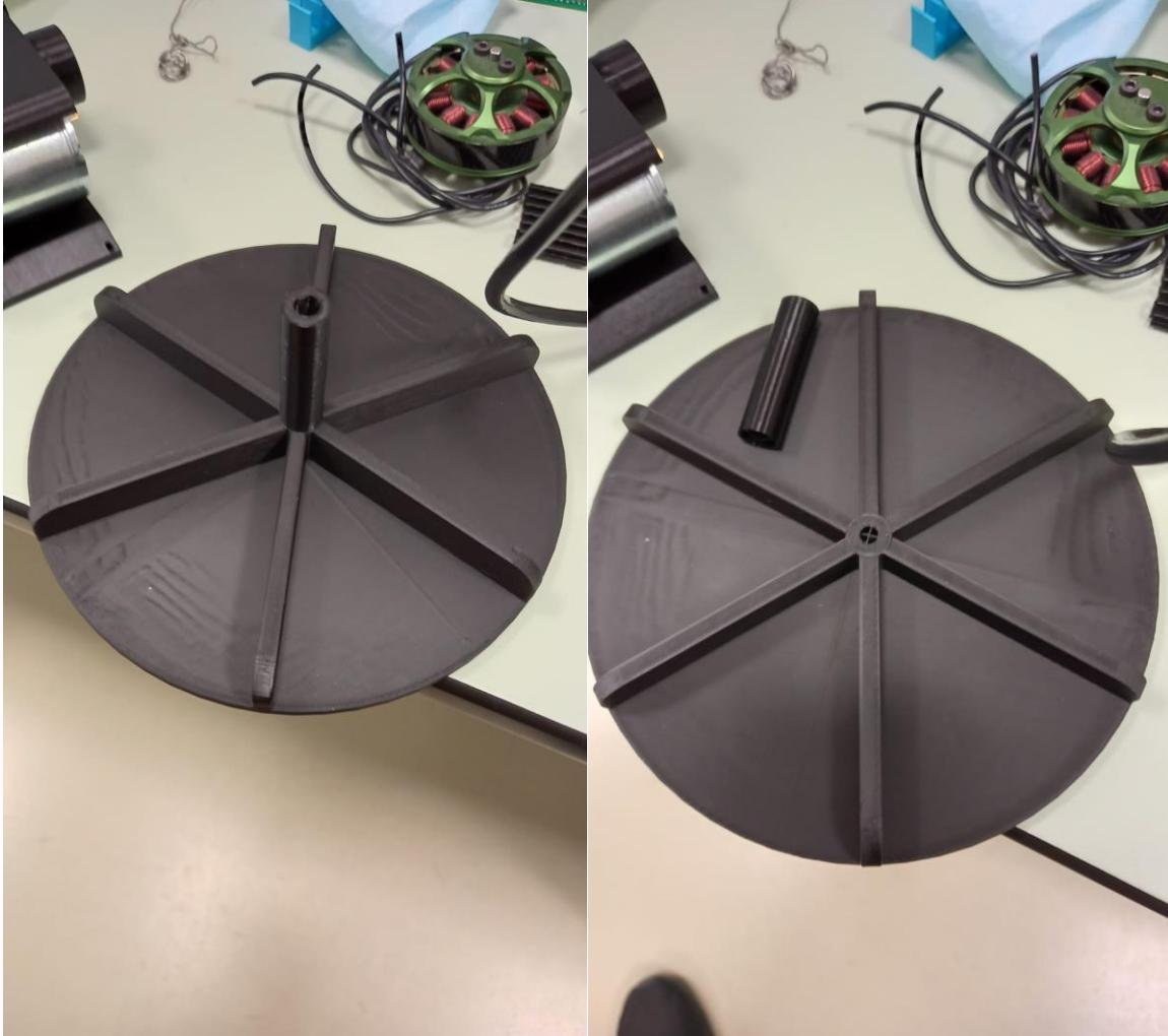
Slika 24: Rotor (lijevo) i greška na rotoru (desno)
