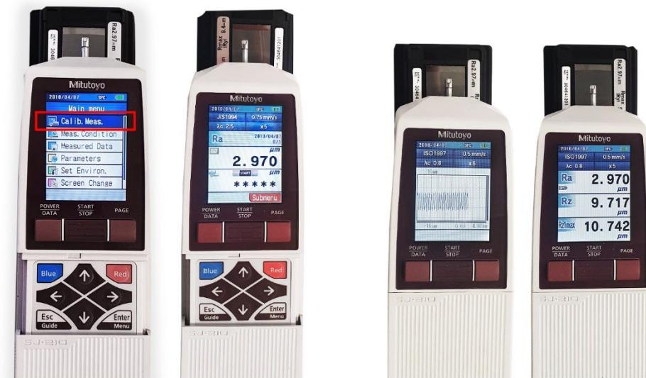
Slika 62. Postupak umjeravanja mjernog uređaja
