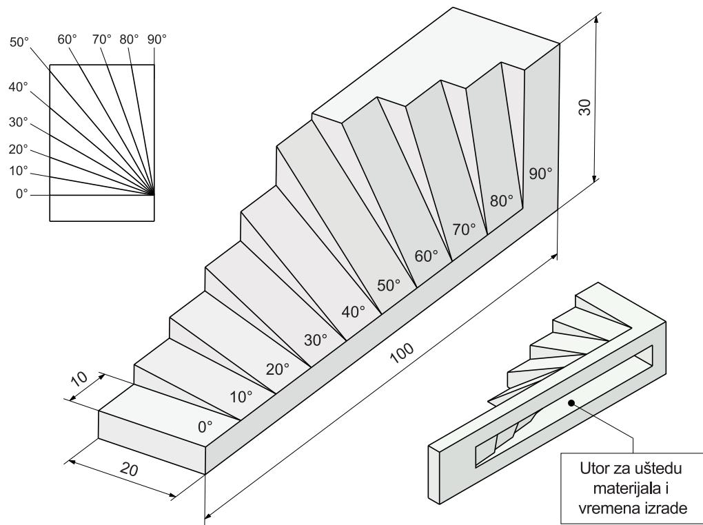
Slika 55. Ispitni uzorak za provedbu eksperimentalnog dijela
