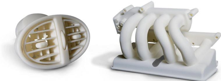
Slika 15. Funkcionalna izrada prototipa za automobil [3] [25]
