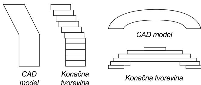
Slika 24. Efekt stepenaste strukture kod FDM metode [8]
