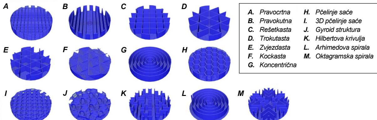
Slika 23. Strukture ispune unutrašnjosti [35]
