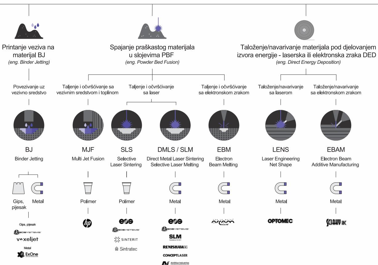
Slika 19. Sistemizacija tehnologija aditivne proizvodnje [19]
