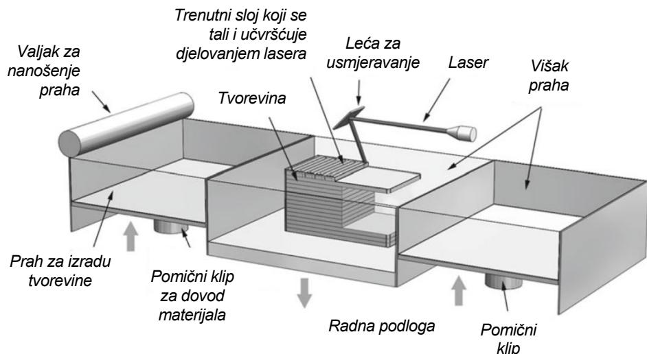
Slika 28. Tehnologija spajanja praškastog materija u slojevima PBF [8]
