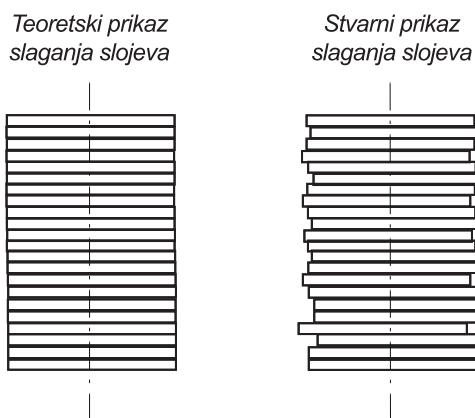
Slika 73. Dislokacija slojeva u aksijalnoj orientaciji [70]
