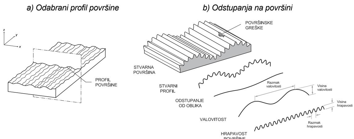
Slika 38. Odabran profil površine i odstupanja na površini [54] [55]
