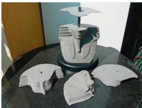
Slika 9. Princip aditivnih postupaka proizvodnje prototipova [4]
