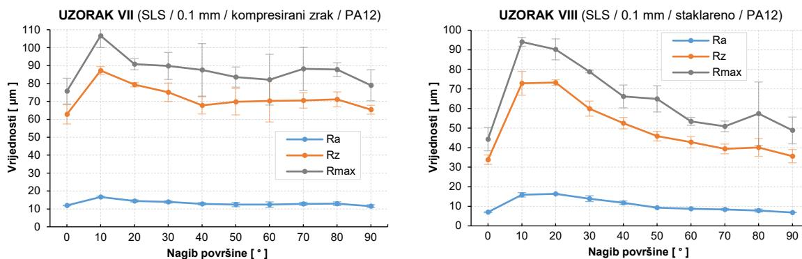
Slika 71. Rezultati mjerjenja uzoraka izrađenih SLS postupkom (PA12 materijal)
