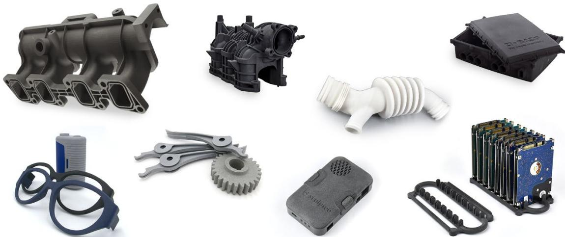
Slika 30. Prikaz primjene SLS postupka [42]
