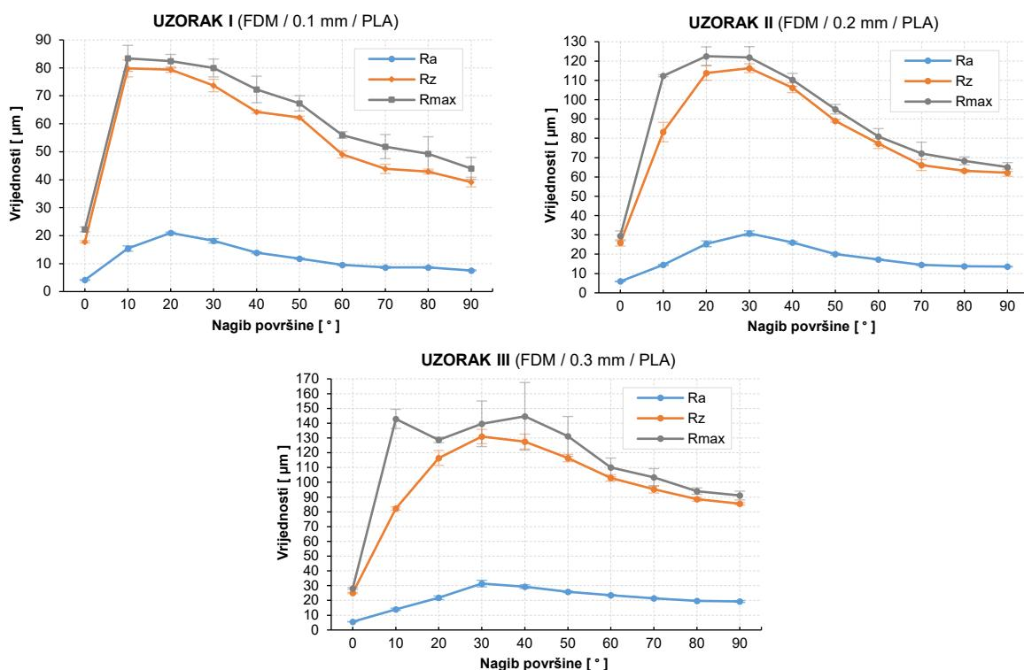
Slika 69. Rezultati mjerjenja uzorka izrađenih FDM postupkom (PLA materijal)
