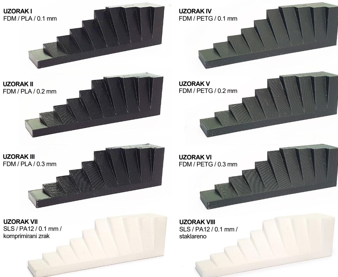
Slika 66. Izrađeni probni uzorci s karakteristikama za provedbu mjerena
