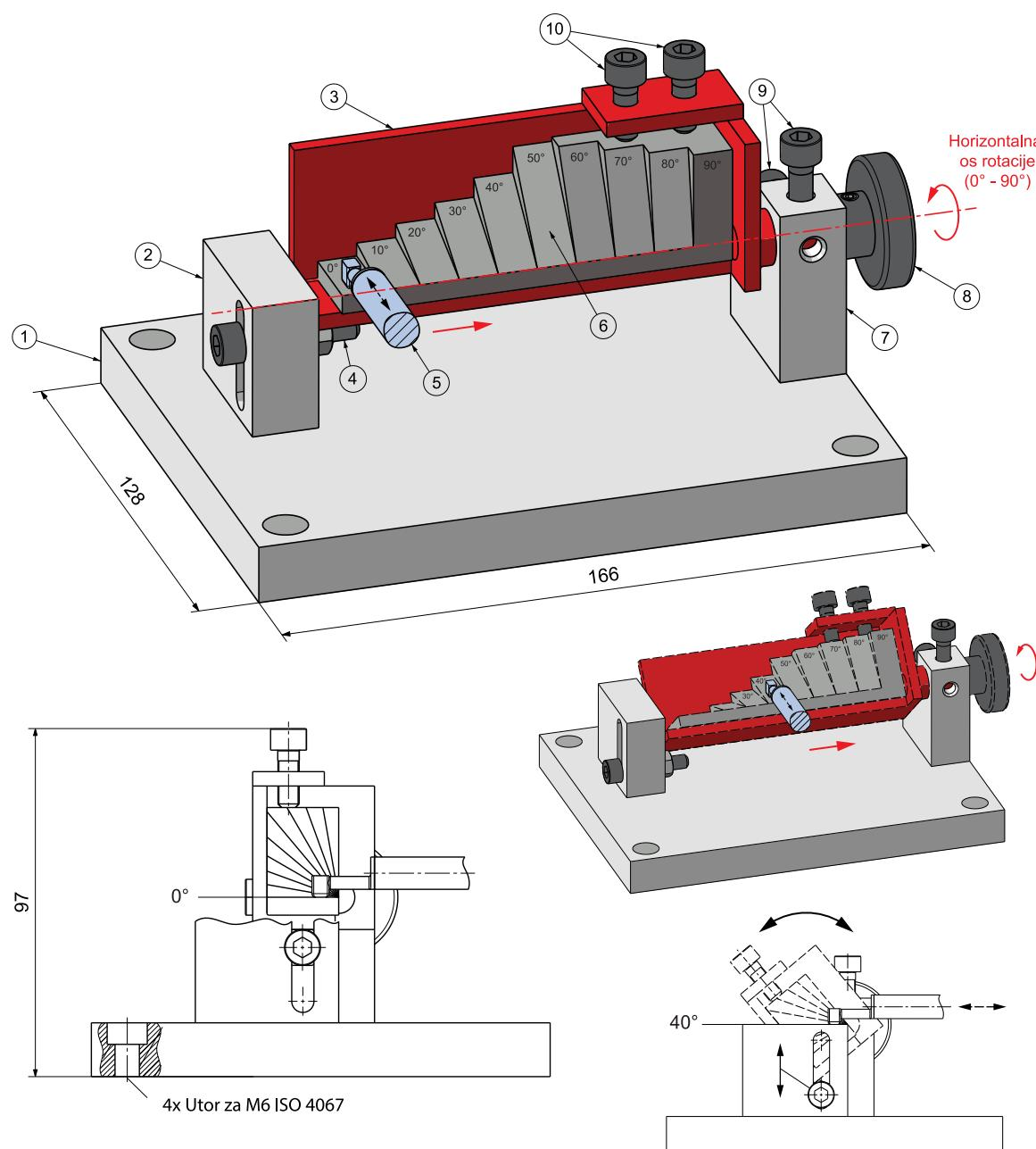
Slika 63. Funkcija pomoćne mjerne naprave za provedbu mjerjenja hrapavosti
