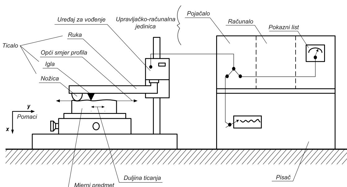
Slika 46. Električno-mehanički mjerni uređaj s ticalom [62]
