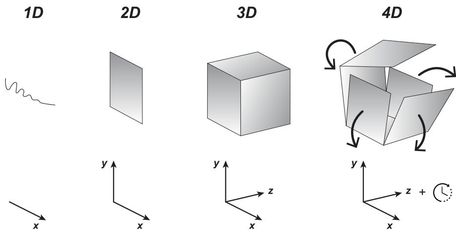
Slika 6. Shematski prikaz dimenzija aditivne tehnologije [14]
