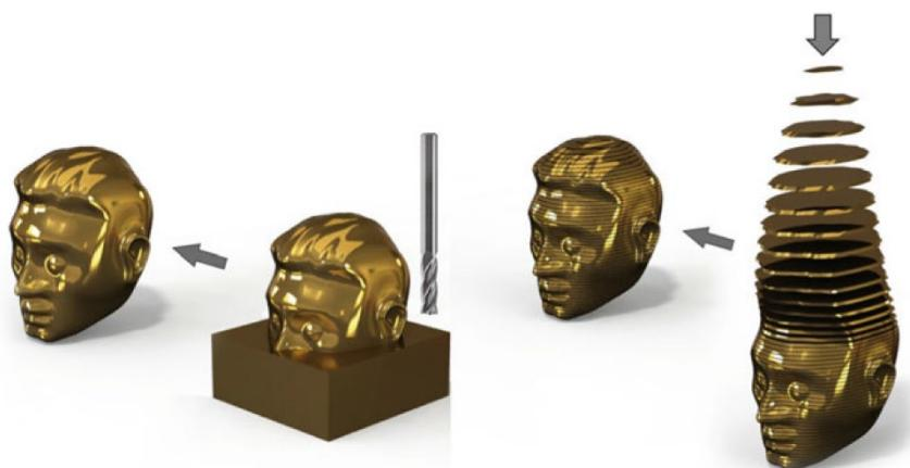
Slika 7. Usporedba subtraktivne i aditivne proizvodnje [8]
