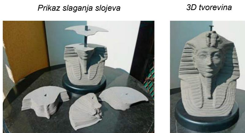
Slika 9. Princip aditivnih postupaka proizvodnje prototipova [4]
