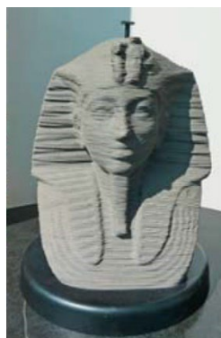
Slika 9. Princip aditivnih postupaka proizvodnje prototipova [4]
