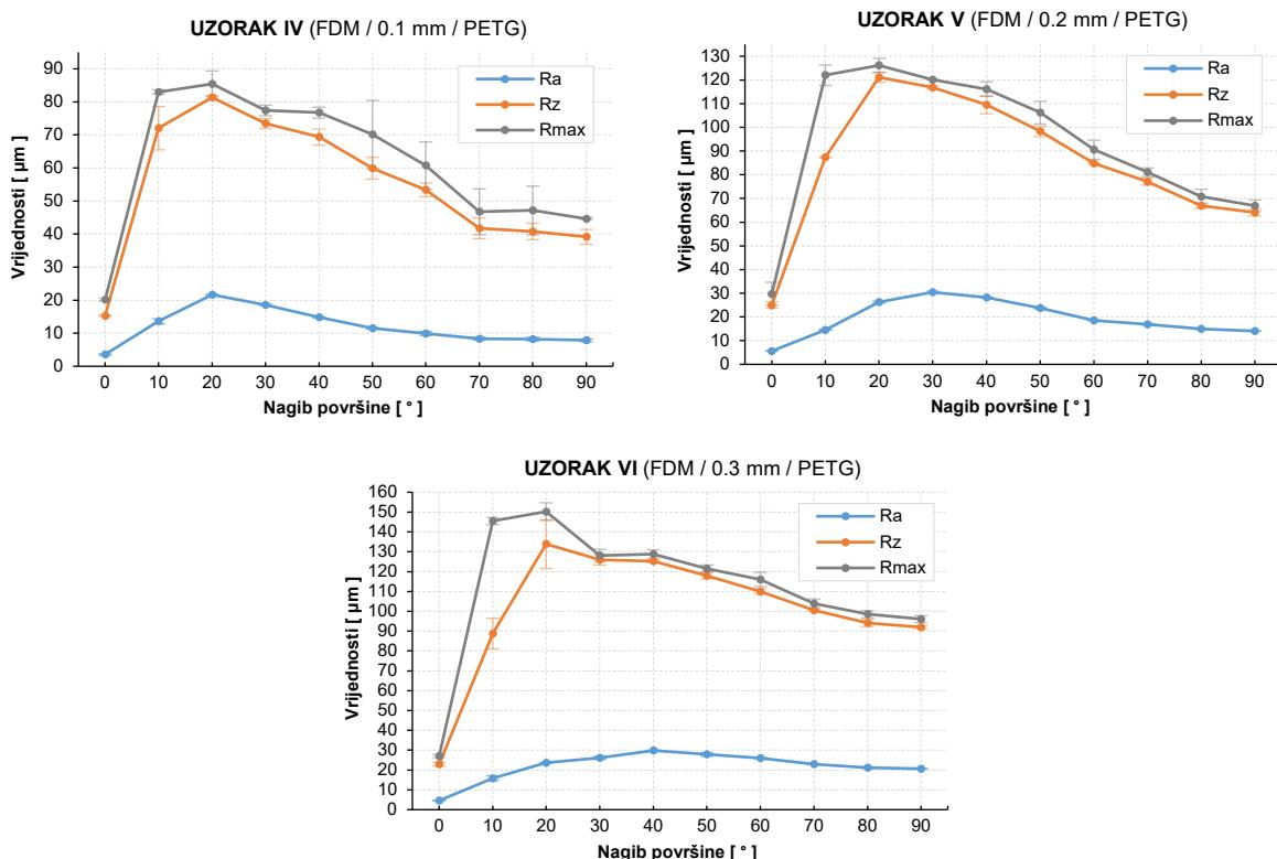
Slika 70. Rezultati mjerjenja uzoraka izrađenih FDM postupkom (PETG materijal)
