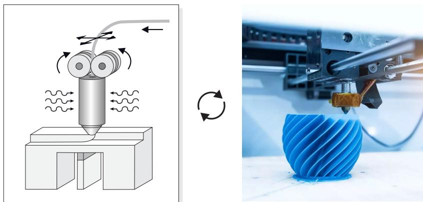
Slika 22. FDM postupak izrade jednog sloja [3]
