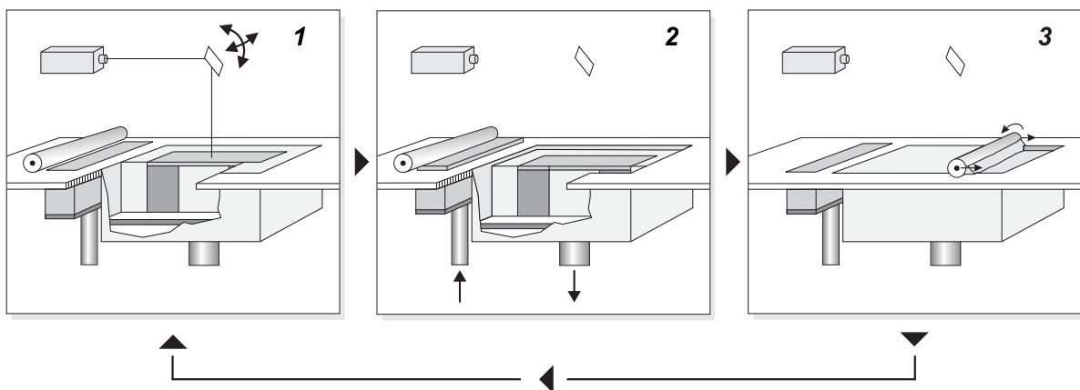
Slika 29. Prikaz postupka selektivnog laserskog sinteriranja SLS [3]
