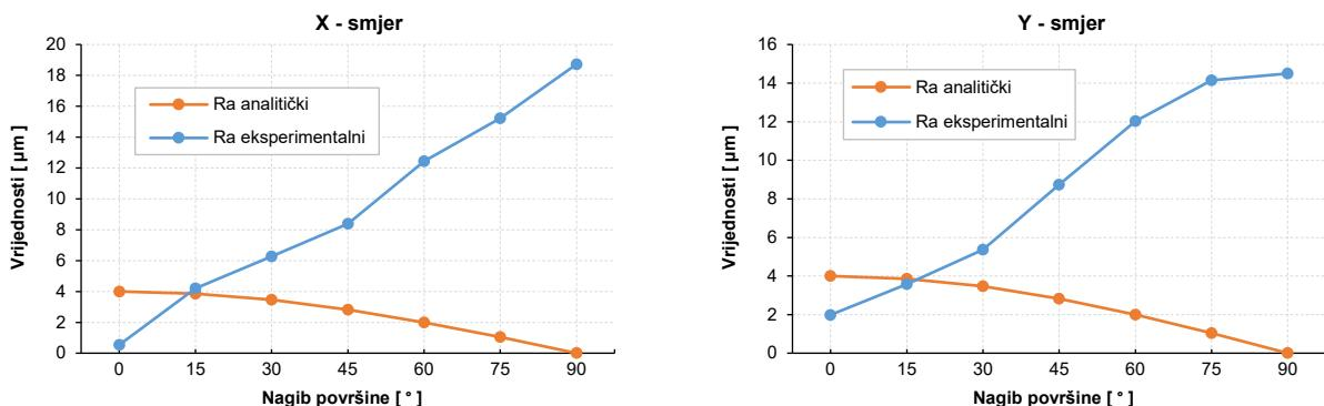
Slika 52. Usporedba eksperimentalnih i analitičkih rezultata u X i Y-smjeru upotreboom postupka PolyJet [73]
