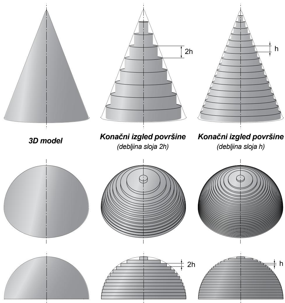
Slika 10. Utjecaj debljine slojeva na konačni izgled površine [17] [18]
