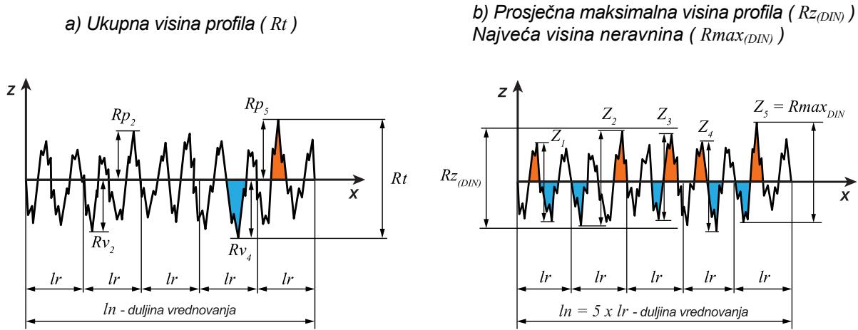
Slika 44. Određivanje parametara  $R_t$ ,  $R_{z(DIN)}$  i  $R_{max}$  [58]
