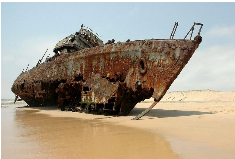
Slika 2. Korozija trupa broda [6]
