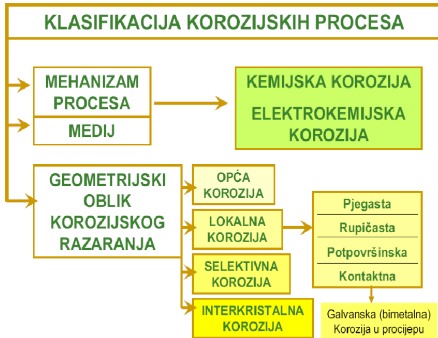
Slika 3. Klasifikacija korozijskih procesa [9]
