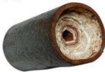
Slika 18. Prikaz cijevi s nakupinama kamenca
