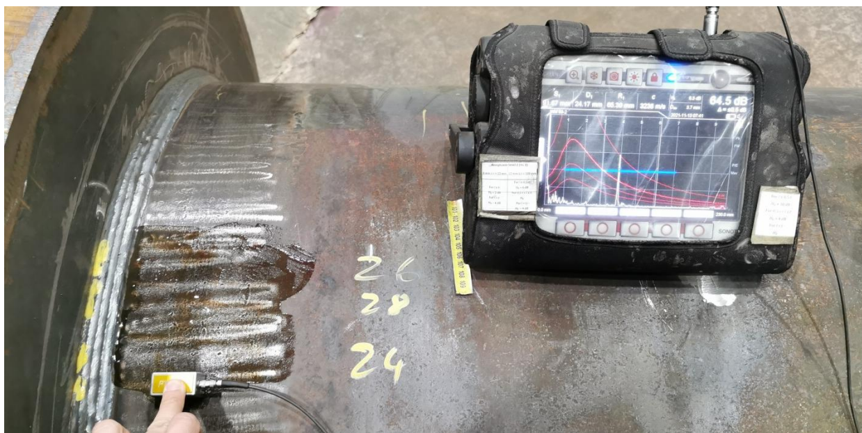
Slika 38. Ultrazvučno ispitivanje zavarenog spoja kutnom sondom i pronalazak indikacija
