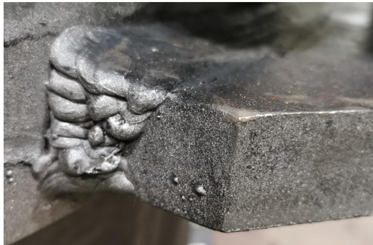
Slika 56. Vizualna nepravilnost na „stopi“
