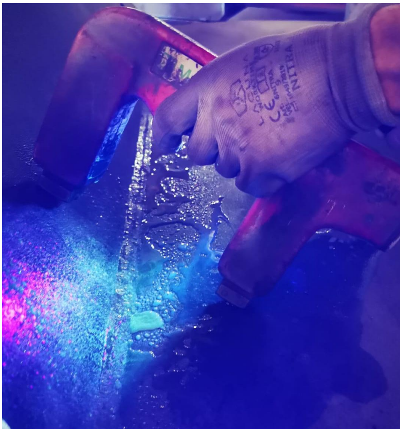
Slika 64. Magnetska kontrola zavarenih spojeva na zapornom tijelu
