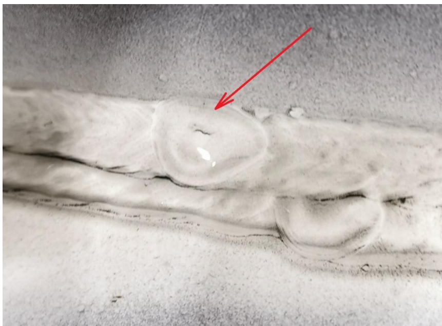
Slika 53. Pukotina u završnom krateru
