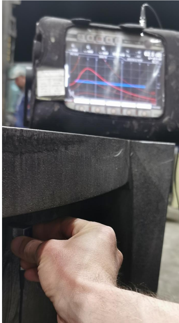
Slika 55. Prikaz rada ultrazvučnom kontrolom pri ispitivanju zavarenih spojeva „plašteva“
