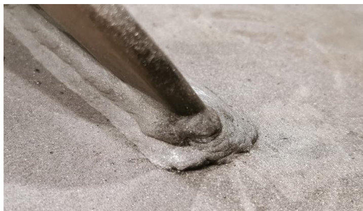
Slika 62. Vizualna greška: preklop zavora
