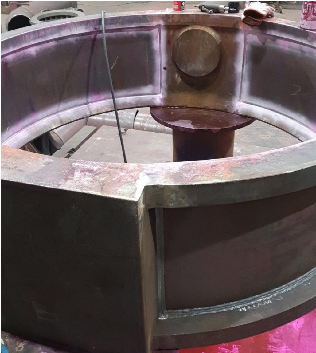
Slika 51. Penetrantska kontrola nakon brušenja korijena
