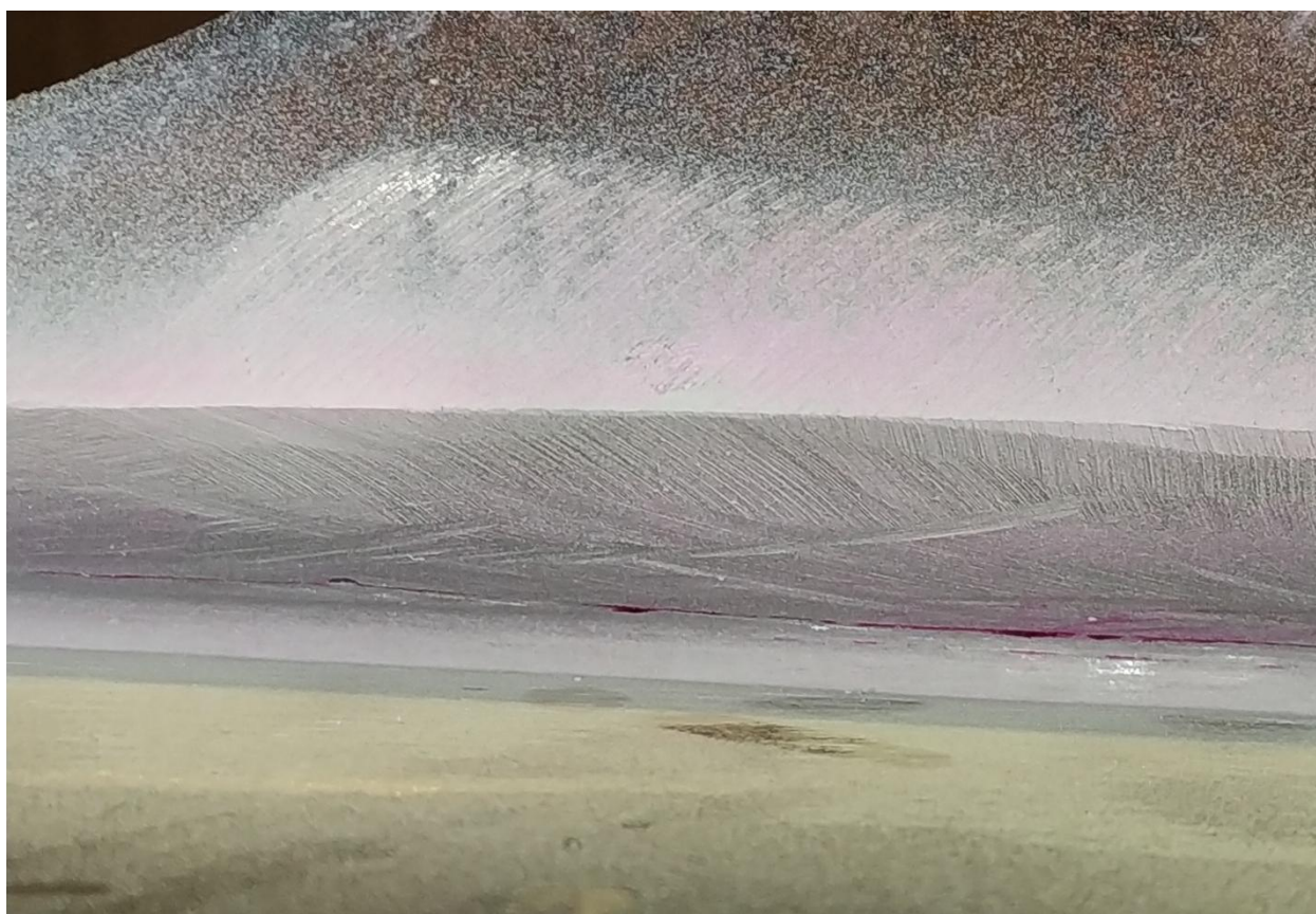
Slika 45. Indikacija prilikom ispitivanja penetrantskom kontrolom
