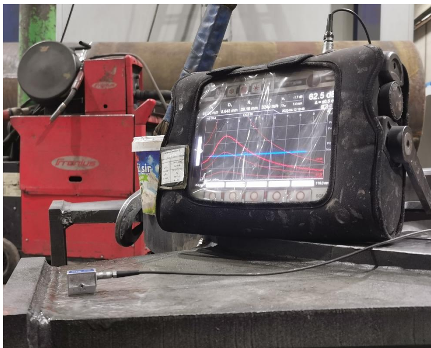
Slika 58. Ultrazvučno ispitivanje zavarenoj spoja „stope“
