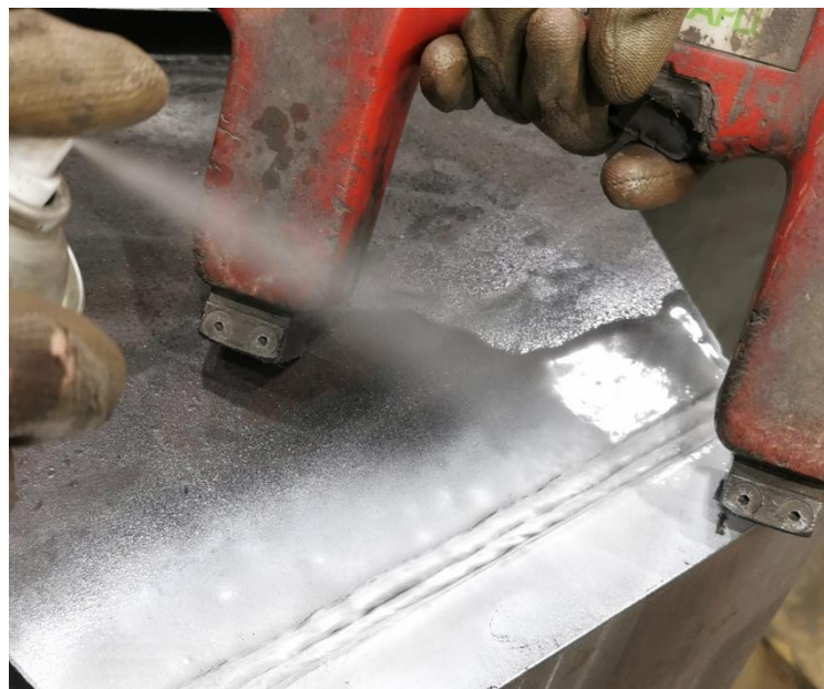
Slika 57. Magnetska kontrola zavarenog spoja „stope“
