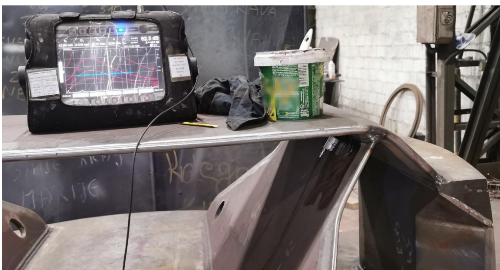
Slika 66. Neprihvatljiva indikacija na spoju dvaju „ojačanja“
