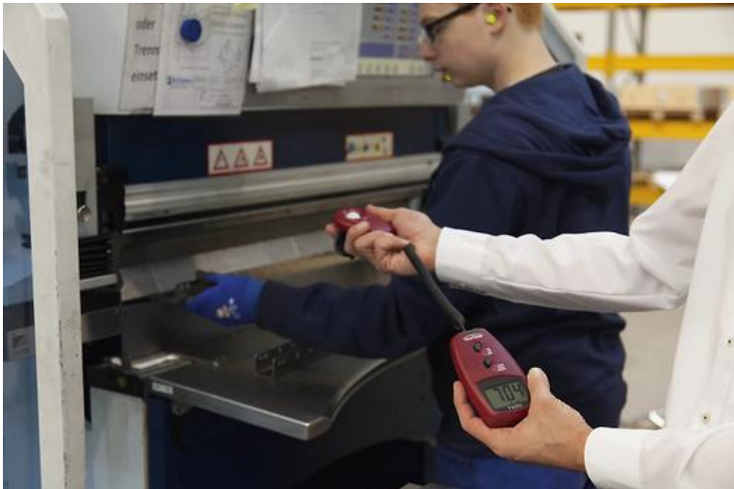
Slika 4. Mjerenje osvjetljenja fotometrom [11]
