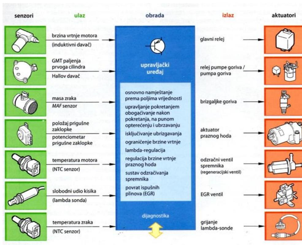
Slika 4: Blok shema senzora, upravljačke jedinice i aktuatora [1]
