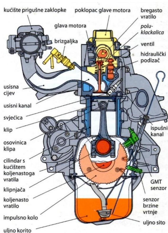
Slika 1: Konstrukcija motora s unutarnjim izgaranjem [1]
