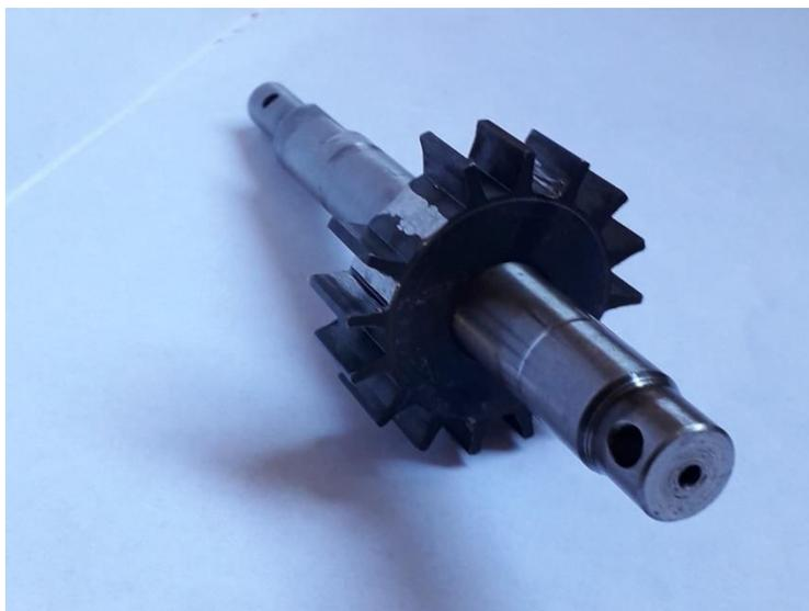
Slika 8: Zupčanik senzora položaja motora
