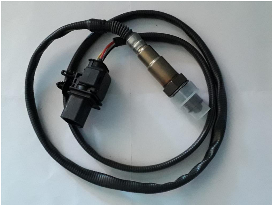
Slika 12: Širokopojasna \lambda -sonda
