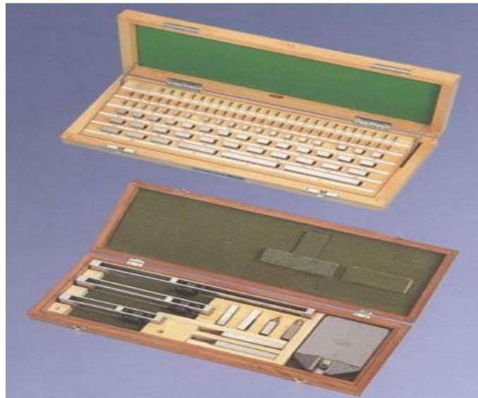
Slika 1. Set paralelnih graničnih mjerki [5]
