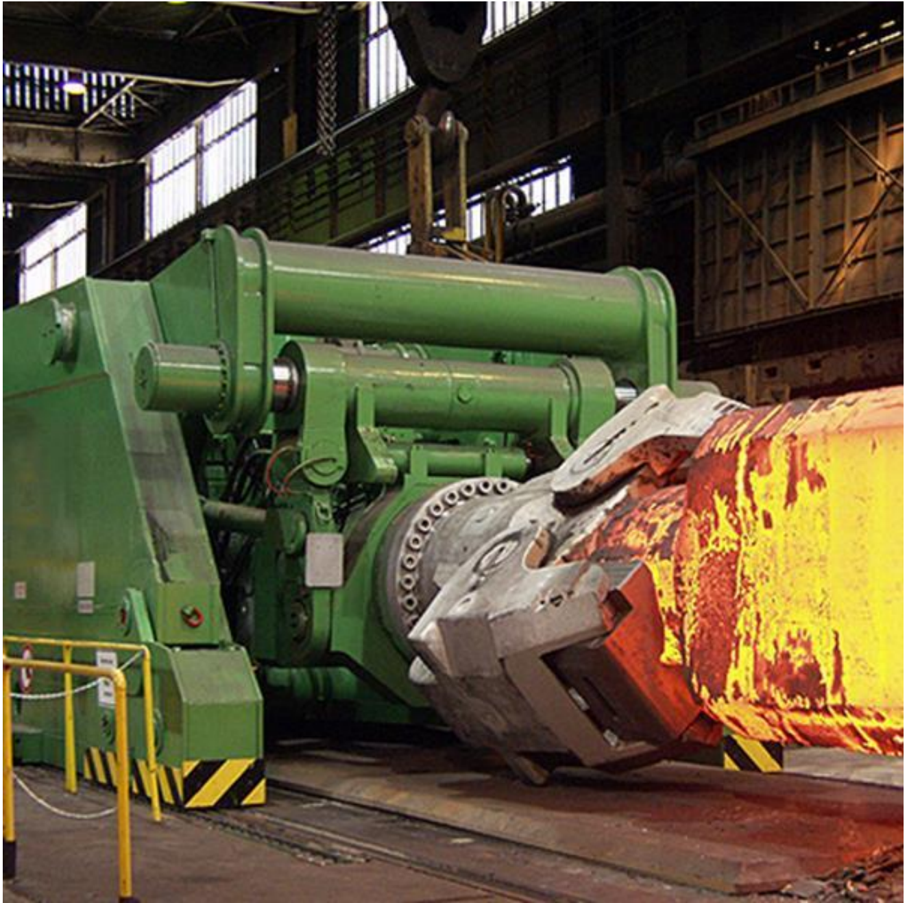
Slika 3 Manipulator za kovanje [4]
