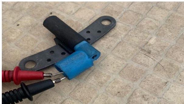
Slika27. Prikaz mjerenja otpora senzora. Izvor [20].
