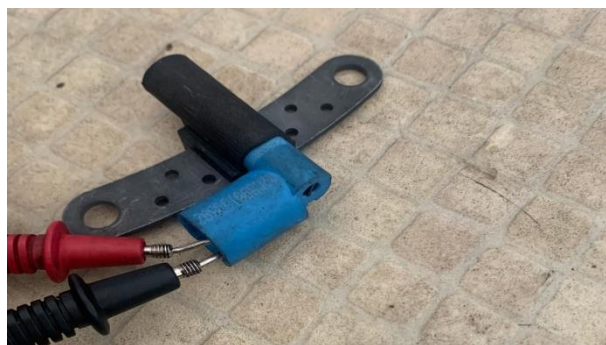
Slika27. Prikaz mjerenja otpora senzora. Izvor [20].
