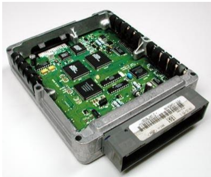
Slika 1. Glavno računalo iz Ford automobila. Izvor [1].
