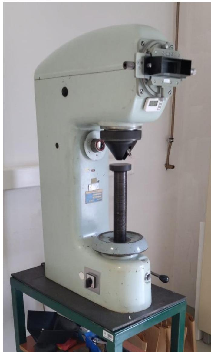
Slika 15. Uredaj za ispitivanje tvrdoće
