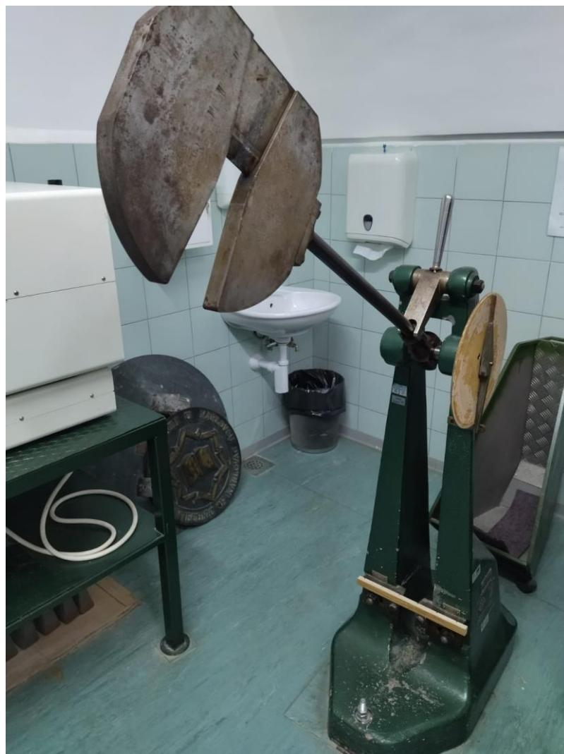
Slika 22. Slika uzorka postavljenog na Charpy batu
