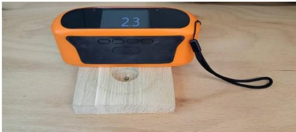
Slika 18. Prikaz mjerjenja sjajnosti površine [1]
