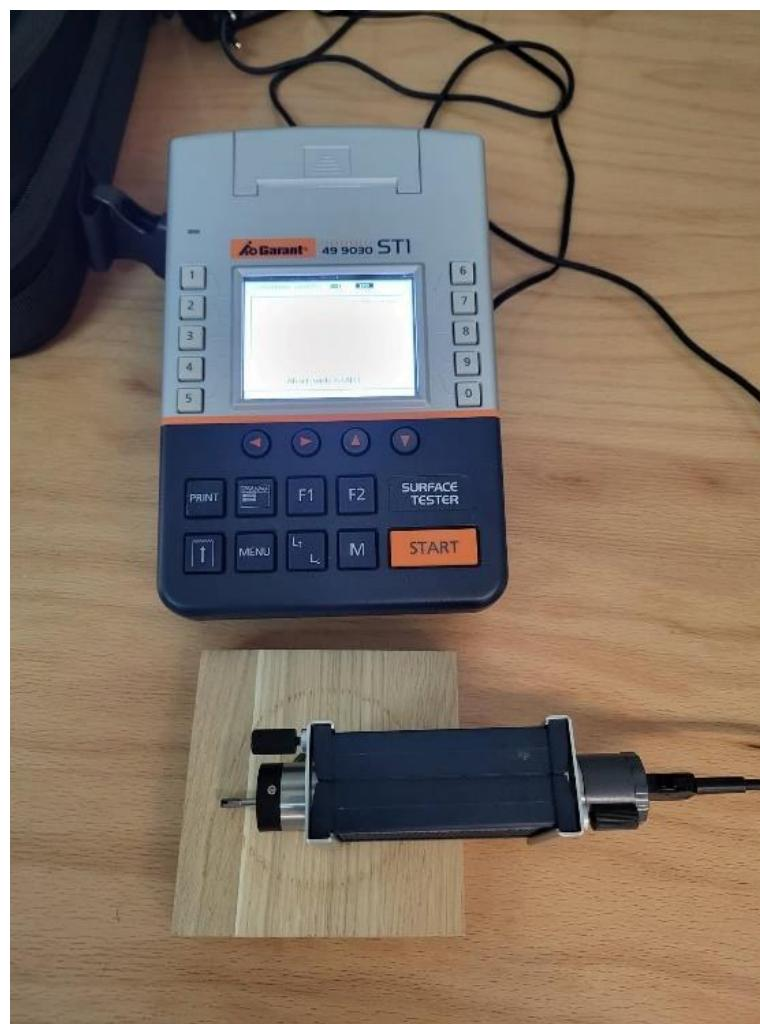
Slika 17. Prikaz ispitivanja hrapavosti površine [1]
