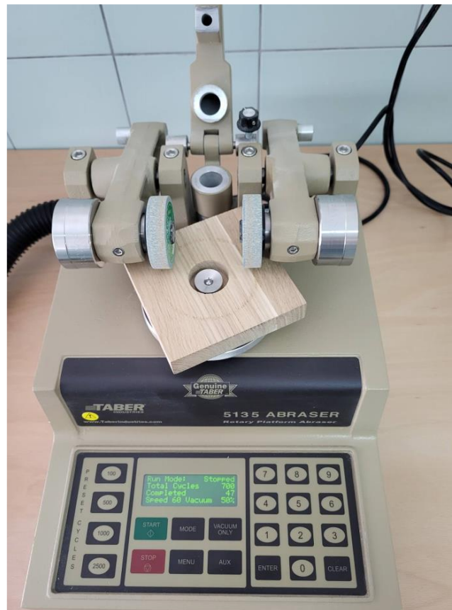
Slika 20. Provođenje Taber testa [1]
