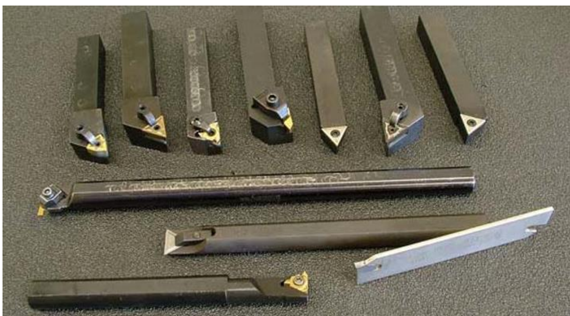
Slika 14 Prikaz različitih varijanti tokarskih noževa [16]
