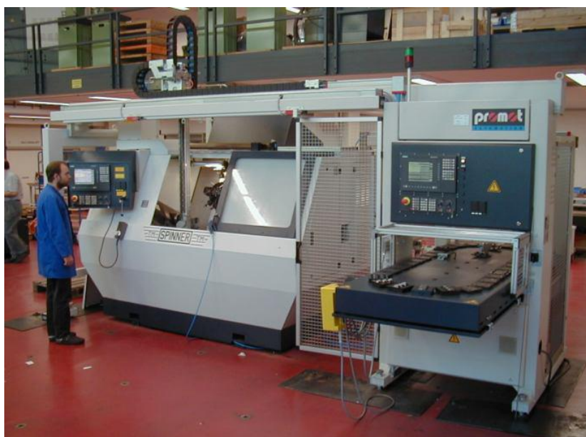
Slika 13 Horizontalna tokarska obradna ćelija [17]
