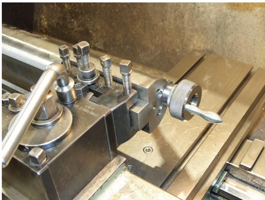
Slika 45 Stezanje naprave na tokarski stroj
