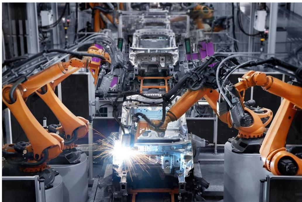
Slika 5. Primjer točkastog zavarivanja u autoindustriji [14]
