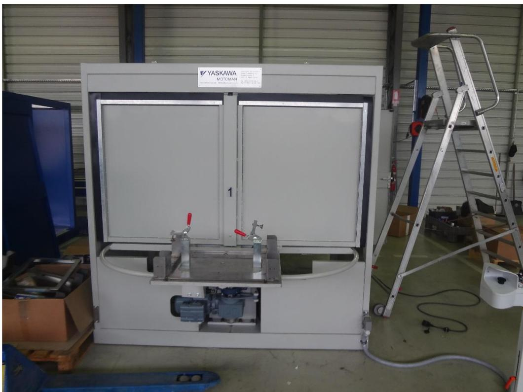
Slika 19. Robotska ćelija za zavarivanje YASKAWA [17]
