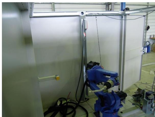
Slika 24. Robot s pištoljem za zavarivanje [17]
