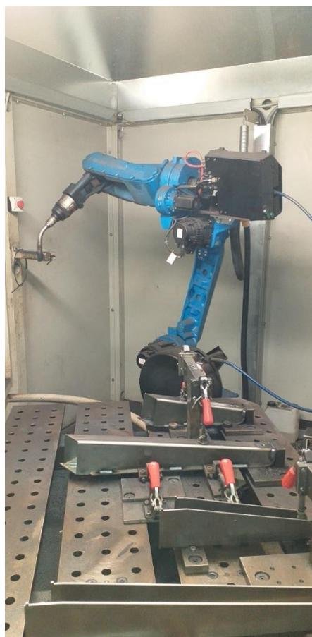
Slika 35. Pištolj u polaznoj točki prije zavarivanja [17]
