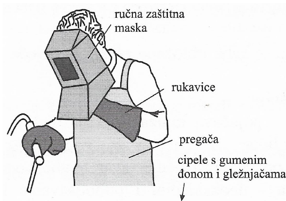
Slika 9. Zaštitna sredstva za rad pri zavarivanju [2]
