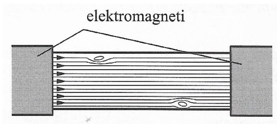
Slika 7. Elektromagnetsko ispitivanje pogrešaka u materijalu [2]
