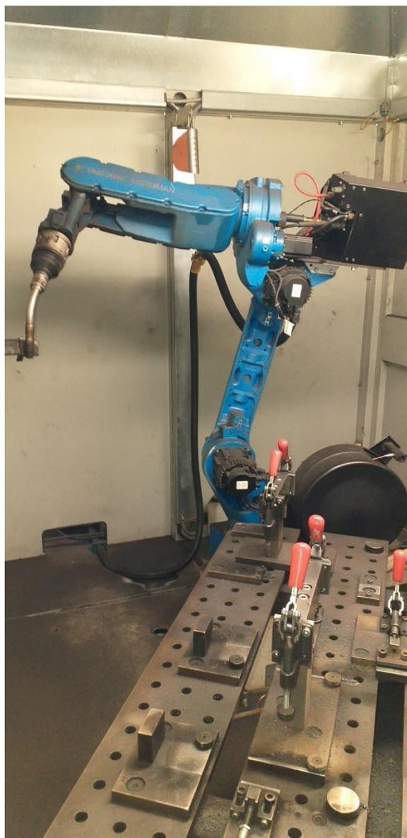
Slika 36. Pištolj u polaznoj točki nakon zavarivanja [17]
