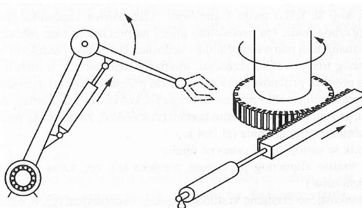
Slika 16. Rotacija robotske ruke uz pomoć hidrauličkog cilindra [7]
