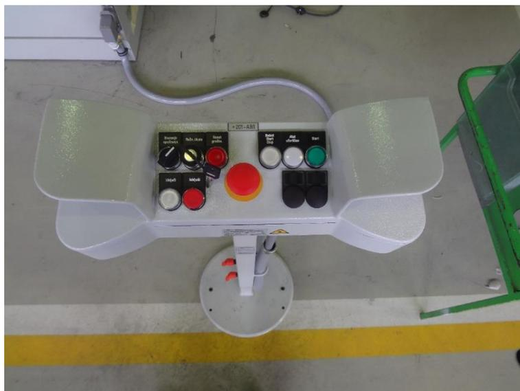
Slika 20. Upravljački pult robotske ćelije [17]
