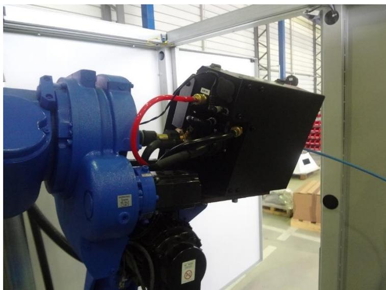
Slika 21. Dio robota s upravljačkom jedinicom [17]
