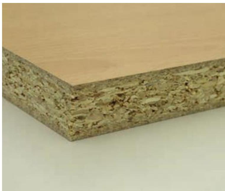
Slika 10. Plastificirana ploča iverica[5]
