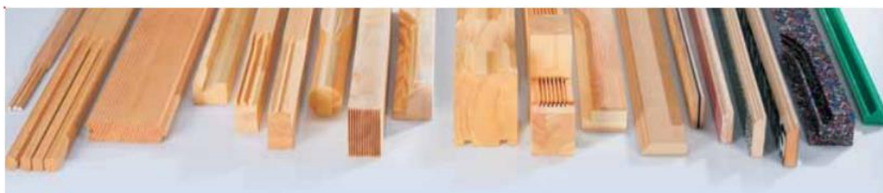
Slika 17. Profili dobiveni glodalima sa izmjenjivom reznom pločicom[5]
