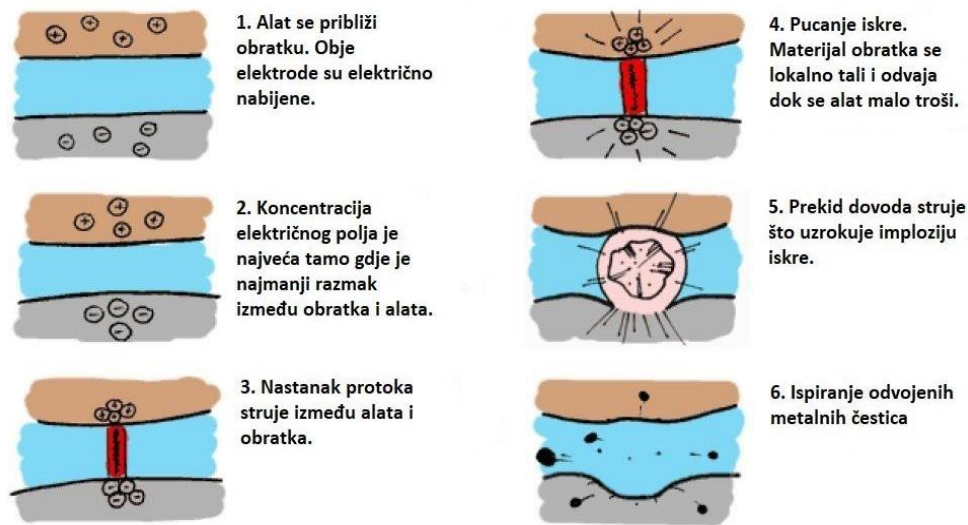
Slika 10 Fizikalno načelo odvajanja čestica elektroerozijom [11]
