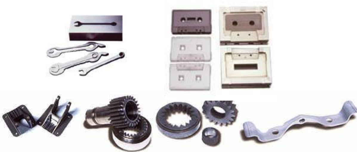
Slika 8 Proizvodi dobiveni elektroerozijom [4]
