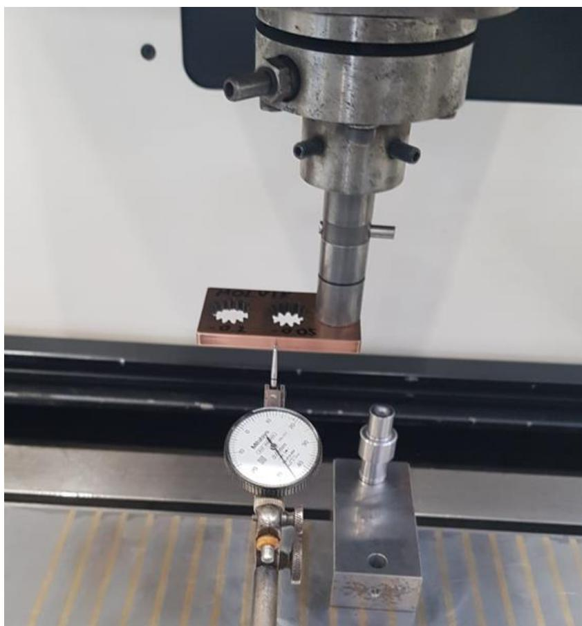
Slika 48 Kompariranje elektrode po x osi
