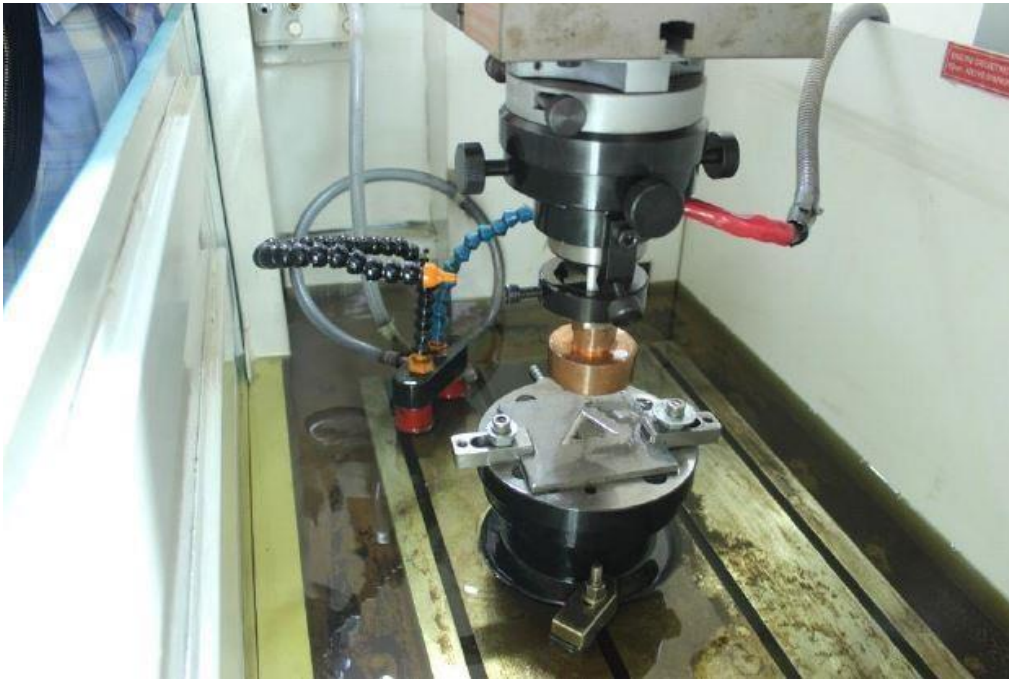
Slika 7 Primjer radnog stola za elektroeroziju žigom [8]
