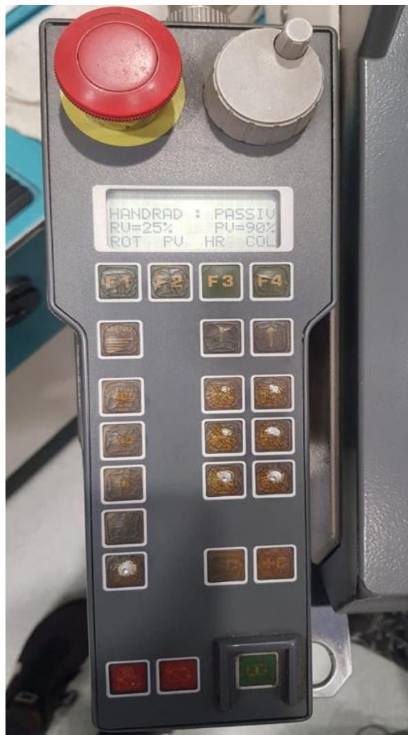
Slika 40 Uređaj za pomicanje alata
