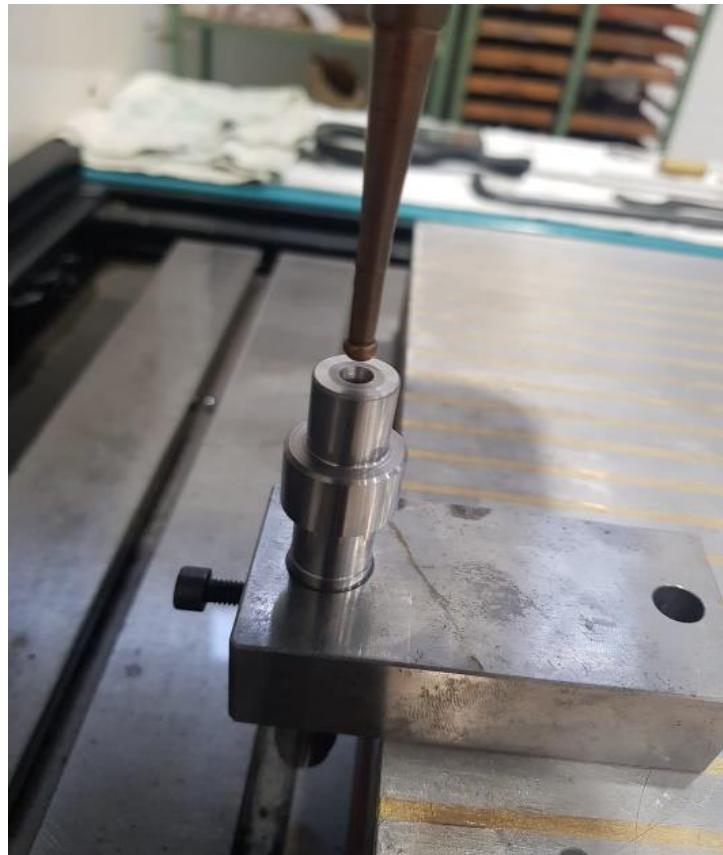
Slika 42 Pozicioniranje ticala u središte vratila
