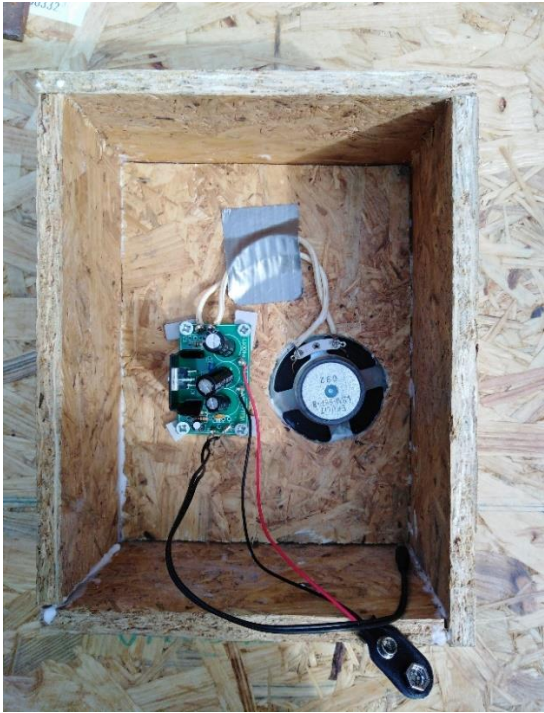
Slika 14. Zvučnička kutija prije postavljanja stražnje stranice
