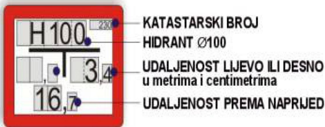
Slika 16. Pločica za oznaku podzemnog hidranta[19]
