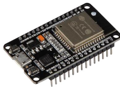
Slika 4. ESP32 mikrokontroler
