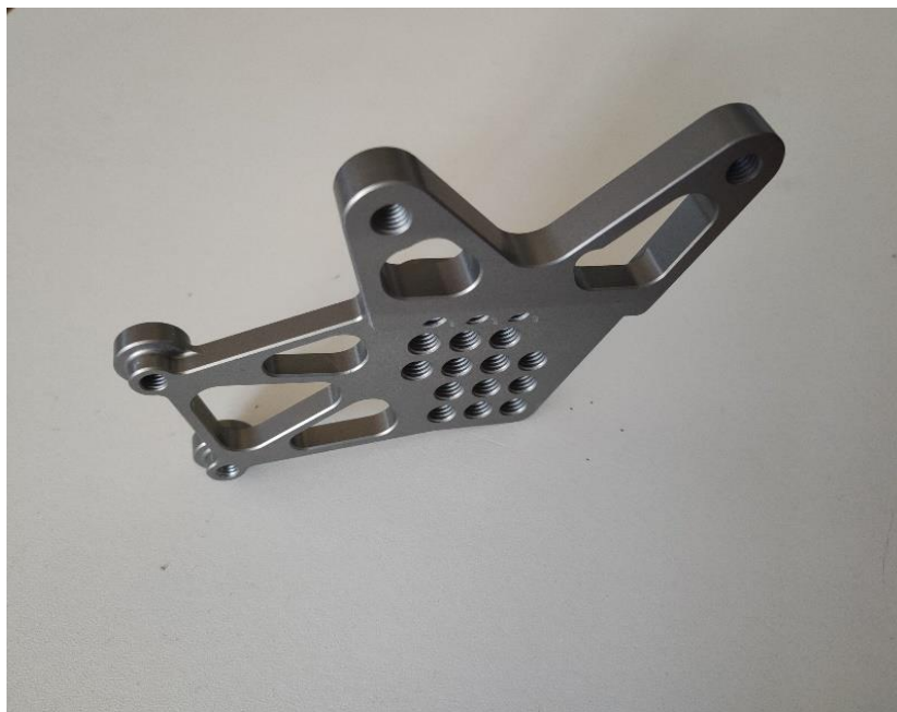
Slika 21. Pozicija EN AW 5083 poslije tvrdog eloksiranja
