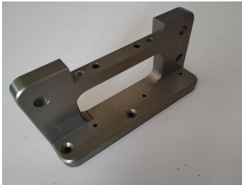
Slika 20. Pozicija EN AW 7072 poslije tvrdog eloksiranja
