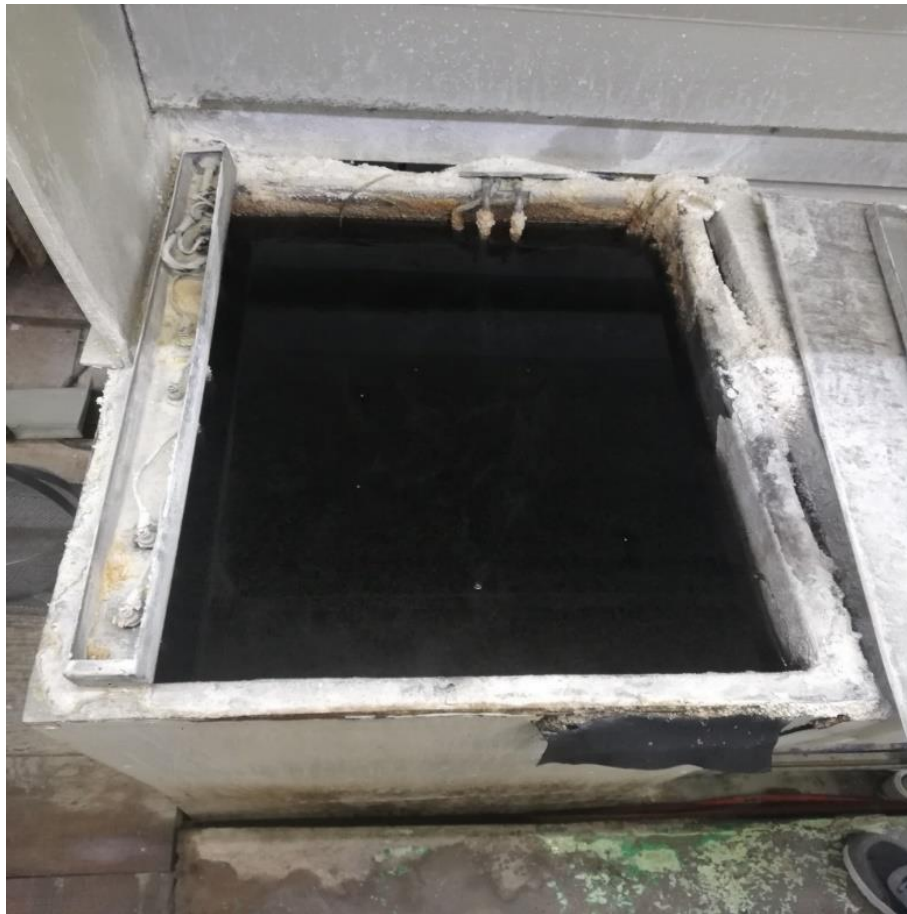
Slika 16. Kad za dekapiranje u otopini NaOH
