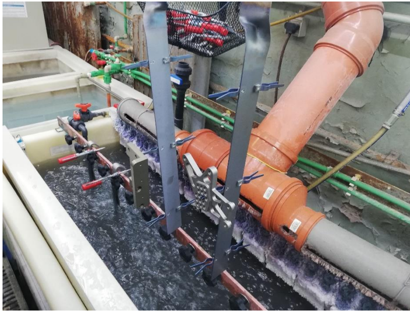
Slika 18. Kada za eloksiranje i postupak
