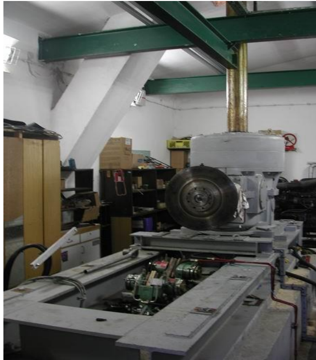
Slika 34. Demontirani motor, kardanski spoj i kočioni sustav [7]
