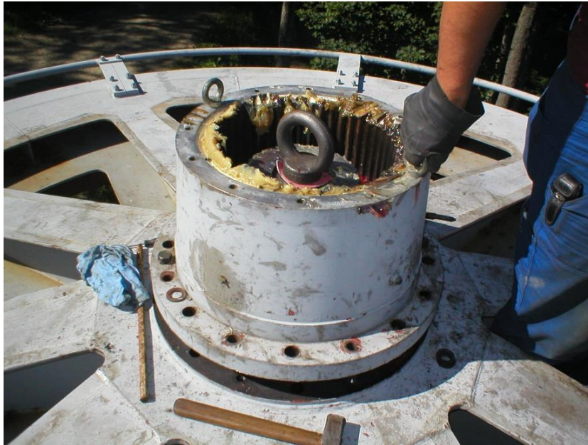
Slika 33. Oslobađanje krune pogonskog kotača i montaža M30 očnog vijka [7]
