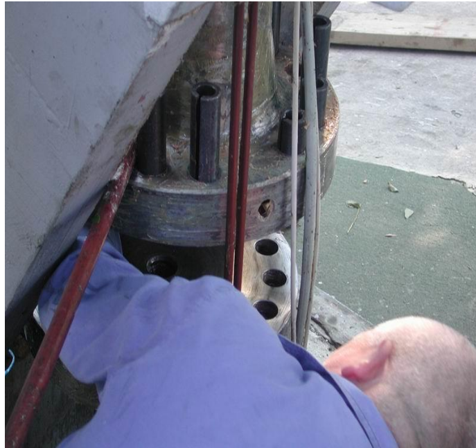
Slika 47. Vezanje vratila mekim gurtnama i atestiranim užetom [7]
