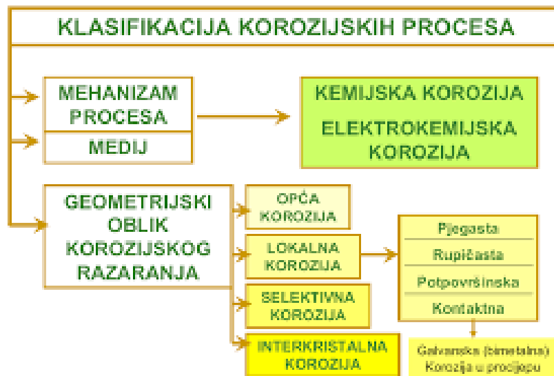
Slika 6. Klasifikacija korozijskih procesa [5]
