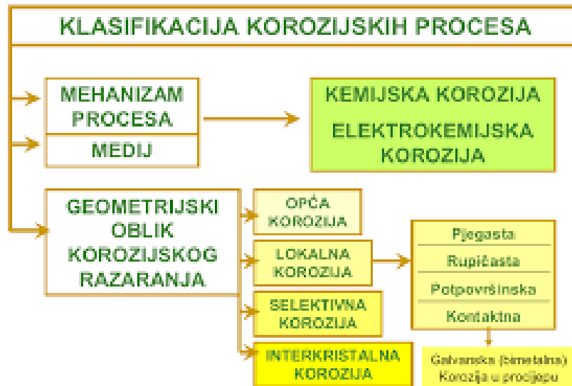
Slika 6. Klasifikacija korozijskih procesa [5]
