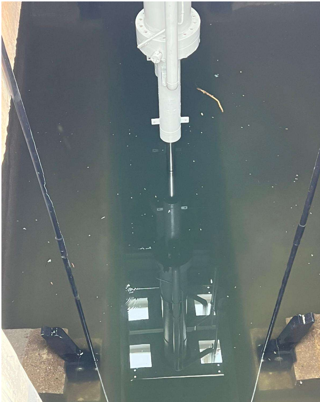
Slika 5.1 Mokra proba zatvarača (ispitivanja kod punog protočnog trakta)
