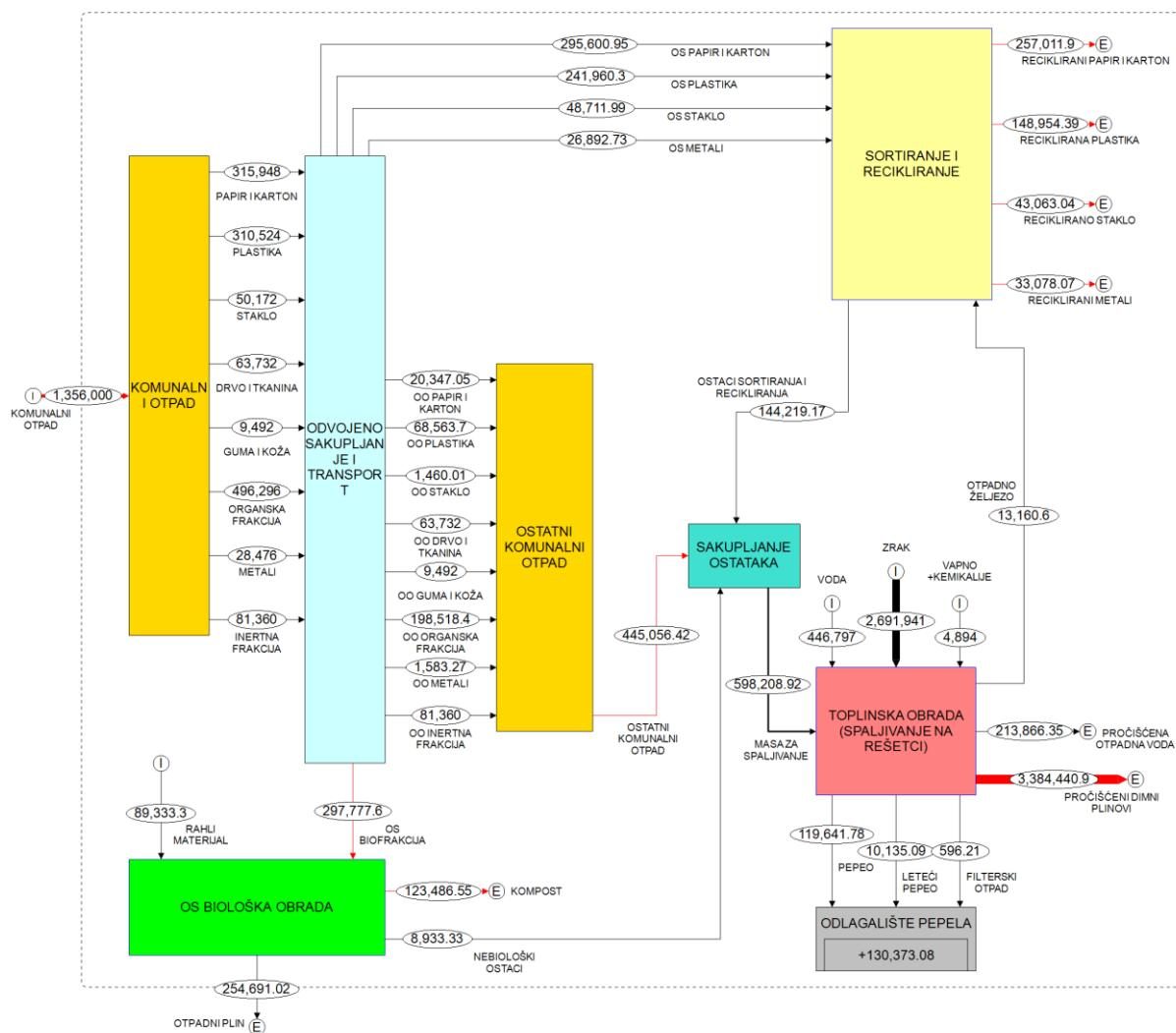
Slika P16. Scenarij B2, materijalni tok, stalni tok komunalnog otpada, 2030.
