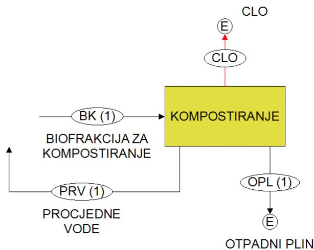
Slika 111. Blok shema izravnog kompostiranja biofrakcije iz ostatnog komunalnog otpada [23].
