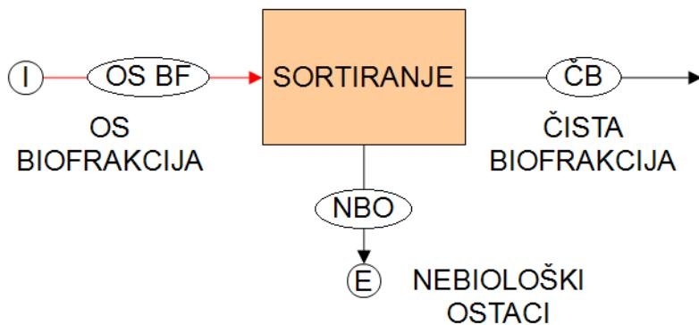
Slika 60. Blok shema sortiranja odvojeno sakupljene biofrakcije [23].
