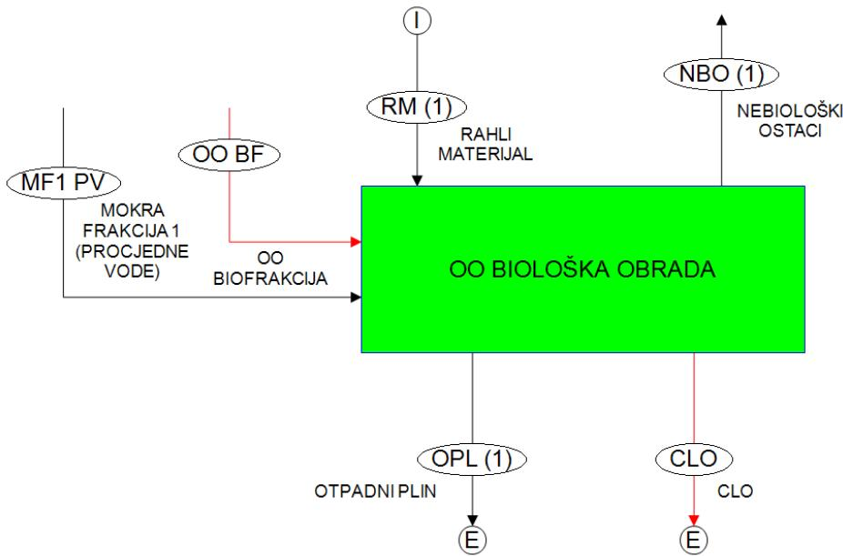
Slika 106. Blok shema sustava modula za bioološku obradu izravnim kompostiranjem biofrakcije iz ostatnog komunalnog otpada.
