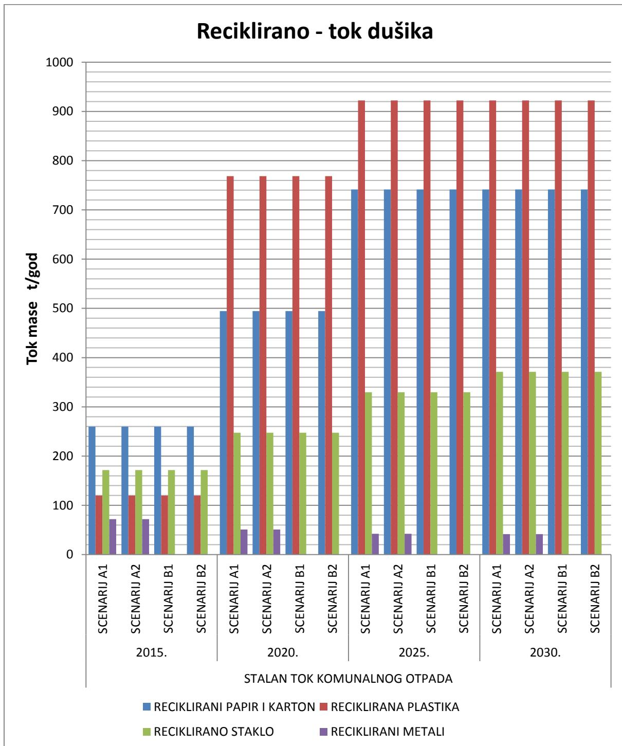
Slika 198. Dijagram usporedbe toka dušika u recikliranom materijalu u scenarijima A1, A2, B1 i B2 za stalan tok komunalnog otpada.
