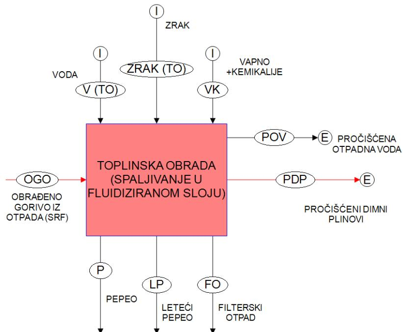
Slika 120. Blok shema modula za toplinsku obradu SRF-a spaljivanjem u fluidiziranom sloju [51]. Udio supstanci (C i N) u vodi je zanemariv, a udio teških metala (Hg, Cd, Pb) u vodi je nula [73]. Udio dušika u zraku je 78,08% [78], a udio ostalih supstanci (Hg, Cd, Pb, C) u zraku je nula. Udio ugljika u vapnu i kemikalijama je 1,53% [79], a udio ostalih supstanci (Hg, Cd, Pb, C) u vapnu i kemikalijama je nula.
