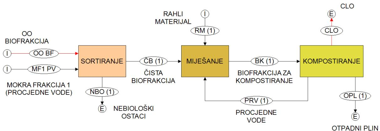
Slika 107. Blok shema podsustava modula za bioološku obradu izravnim kompostiranjem biofrakcije iz ostatnog komunalnog otpada [23].
