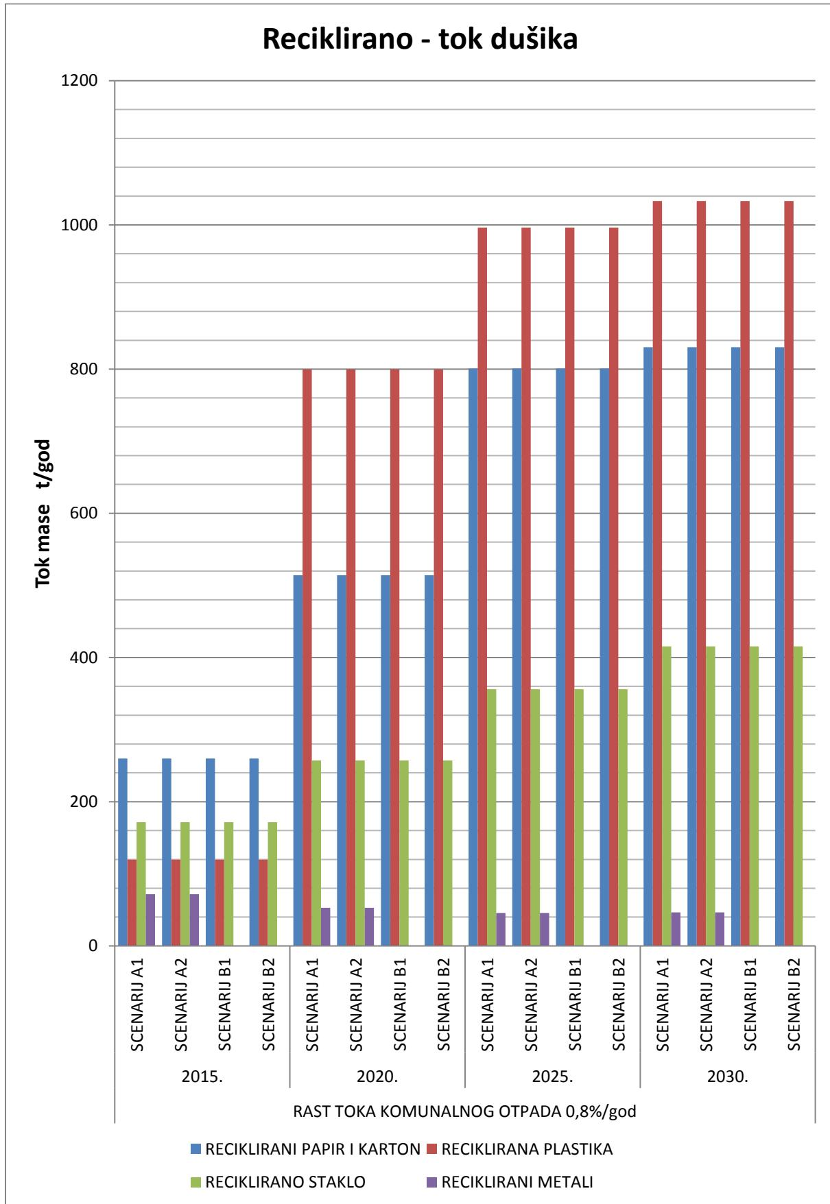
Slika 200. Dijagram usporedbe toka dušika u recikliranom materijalu u scenarijima A1, A2, B1 i B2 za rast toka komunalnog otpada.
