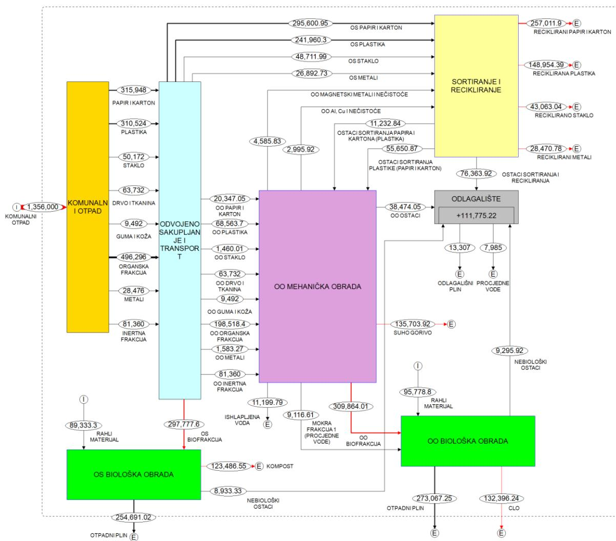
Slika P8. Scenarij A2, materijalni tok, stalni tok komunalnog otpada, 2030.
