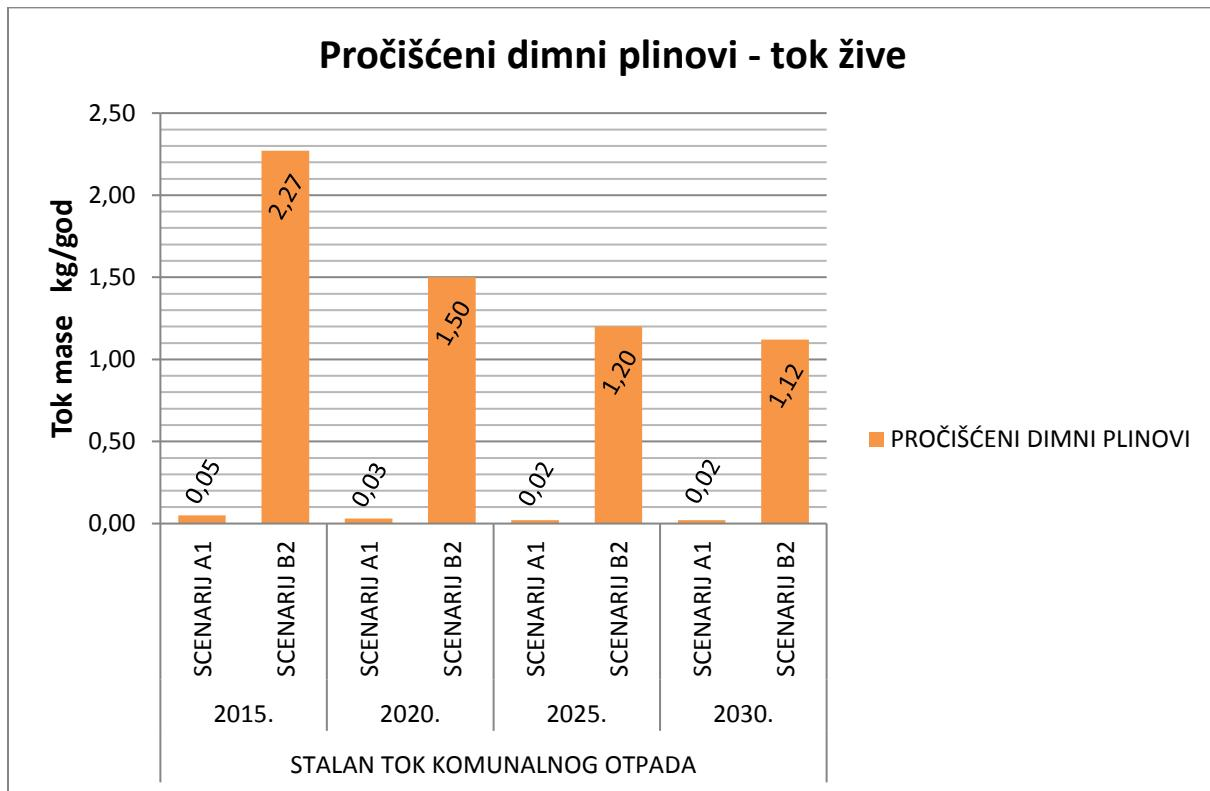
Slika 222. Dijagram usporedbe toka žive u pročišćenim dimnim plinovima u scenarijima A1 i B2 za stalni tok komunalnog otpada.
