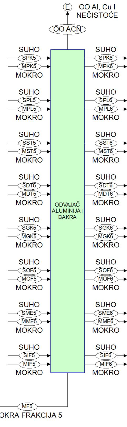
Slika 81. Blok shema sustava odvajača aluminija i bakra.
