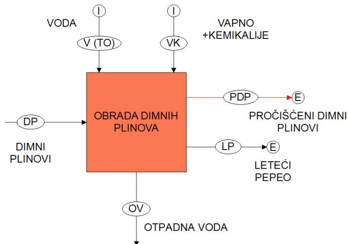
Slika 124. Blok shema obrade dimnih plinova [51].
