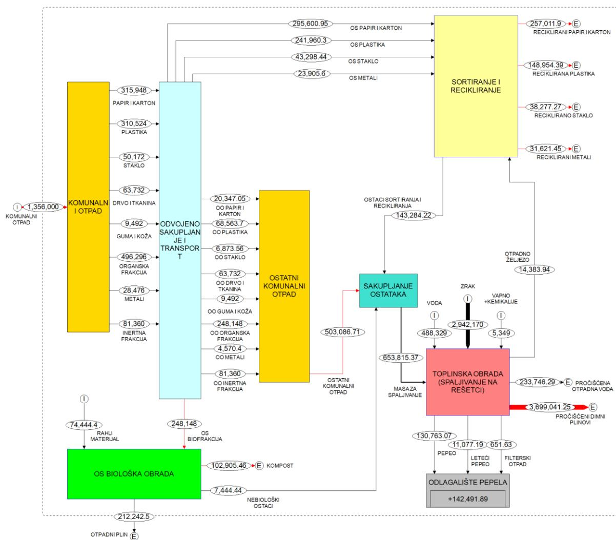
Slika P15. Scenarij B2, materijalni tok, stalni tok komunalnog otpada, 2025.
