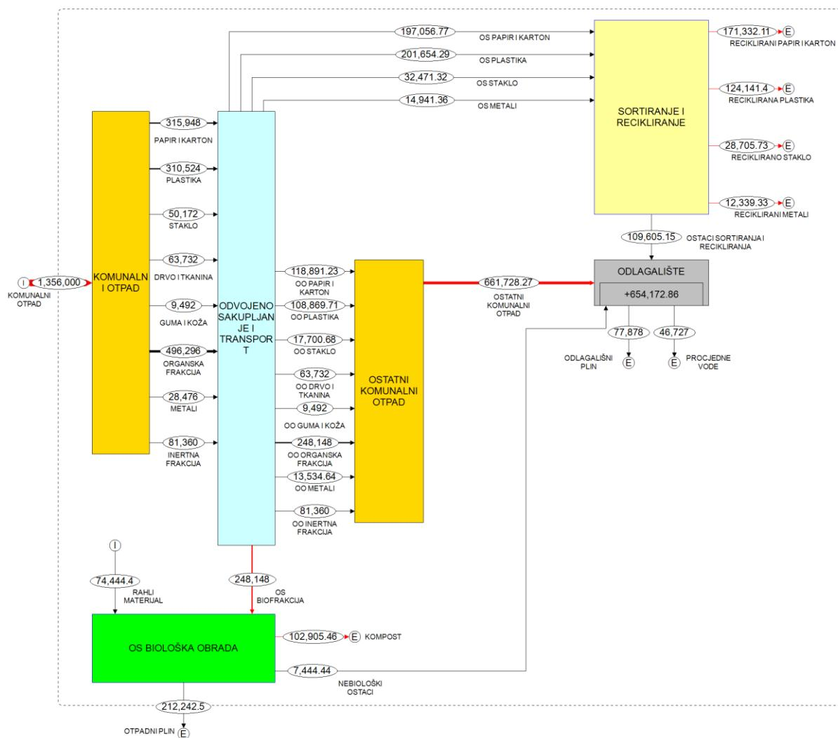
Slika P10. Scenarij B1, materijalni tok, stalni tok komunalnog otpada, 2020.
