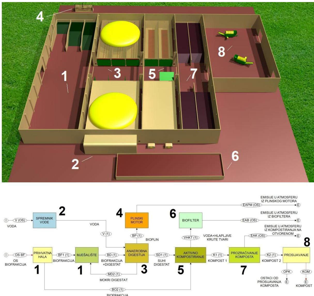
Slika 4. Modul za biošku obradu (gore) i blok shema modula [20] (dolje).
