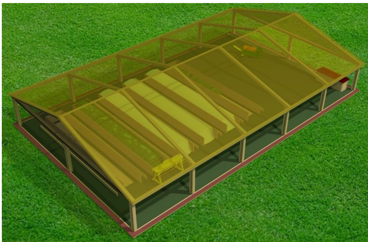
Slika 5. Panoramski prikaz modula za izravno kompostiranje biofrakcije.
