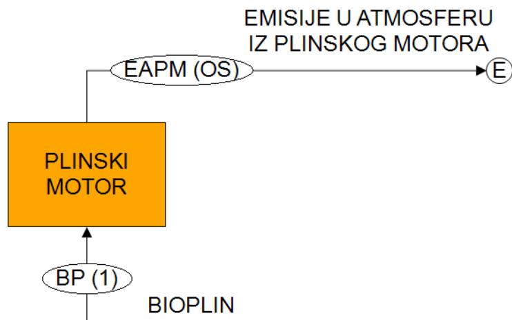
Slika 49. Blok shema plinskog motora [20].
