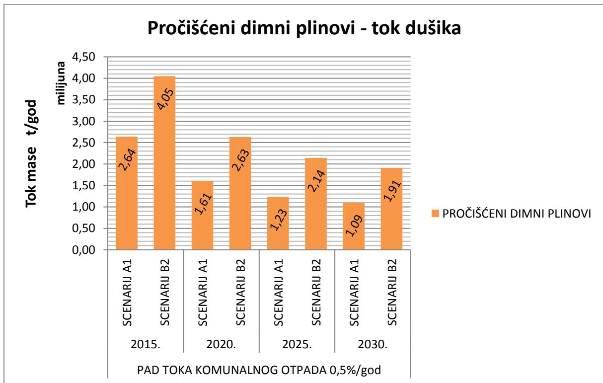
Slika 235. Dijagram usporedbe toka dušika u pročišćenim dimnim plinovima u scenarijima A1 i B2 za pad toku komunalnog otpada.
