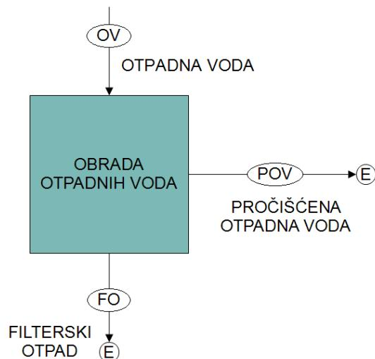
Slika 125. Blok shema obrade otpadnih voda [51].
