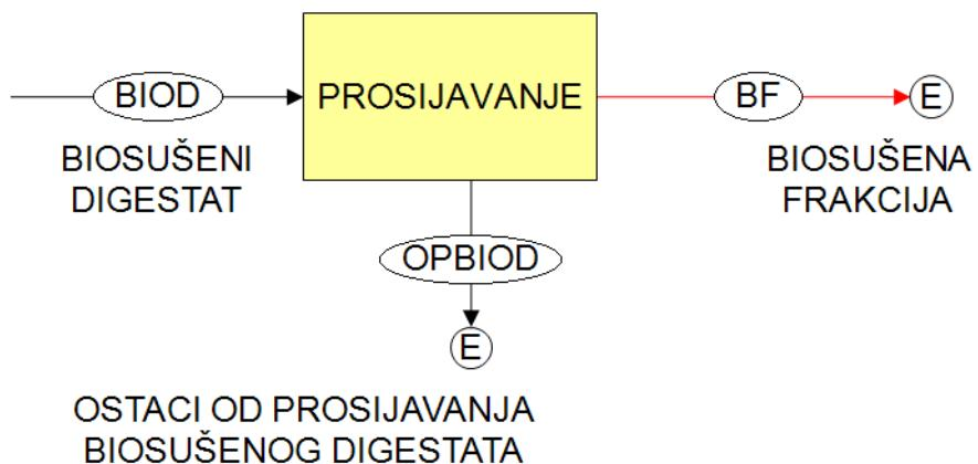
Slika 105. Blok shema sekcije za prosijavanje biosušenog digestata.
