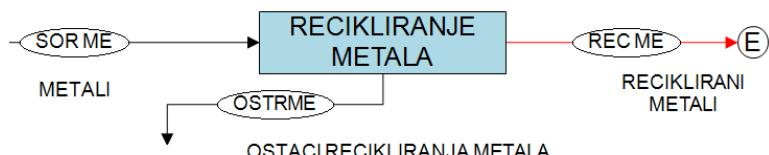
Slika 34. Blok shema recikliranja metala.
