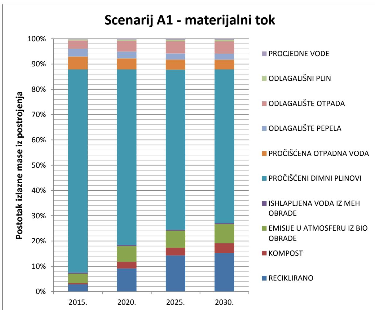
Slika 133. Postotni dijagram materijalnog toka u izlaznim proizvodima i na odlagalištu u scenariju A1 za stalni tok, pad toka i rast toka komunalnog otpada.
