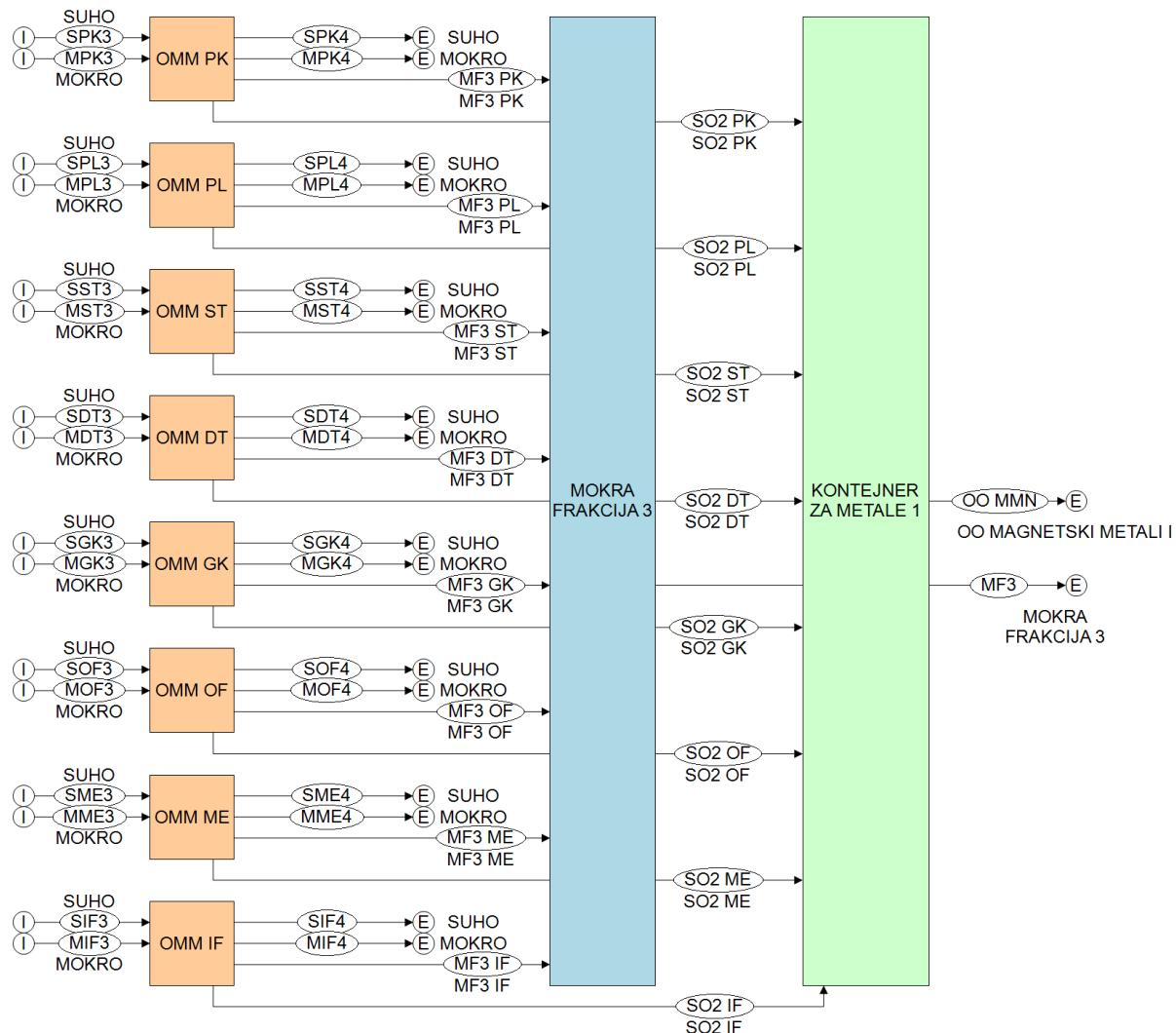
Slika 76. Blok shema podsustava odvajača magnetskih metala.
