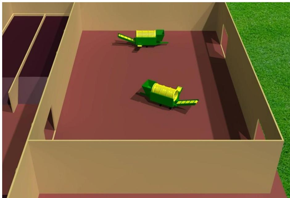
Slika 104. Sekcija za prosijavanje biosušenog digestata.
