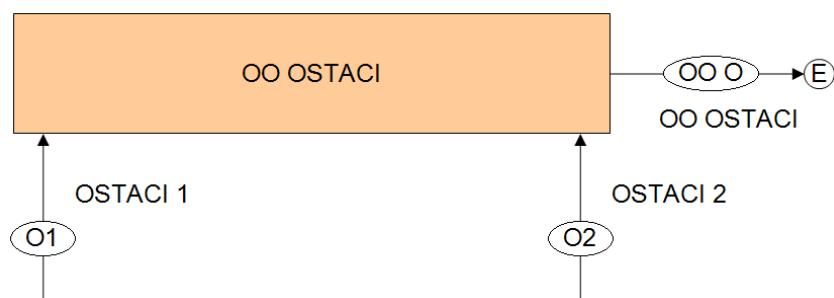
Slika 88. Blok shema sakupljanja ostataka iz zvjezdastog sita (Ostaci 1) i zračnog klasifikatora (Ostaci 2).
