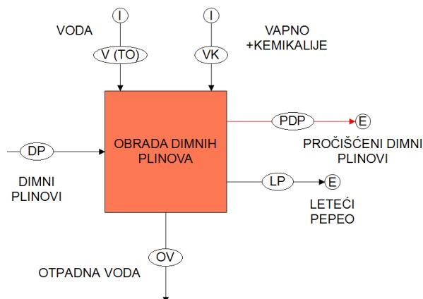
Slika 118. Blok shema obrade dimnih plinova [51].
