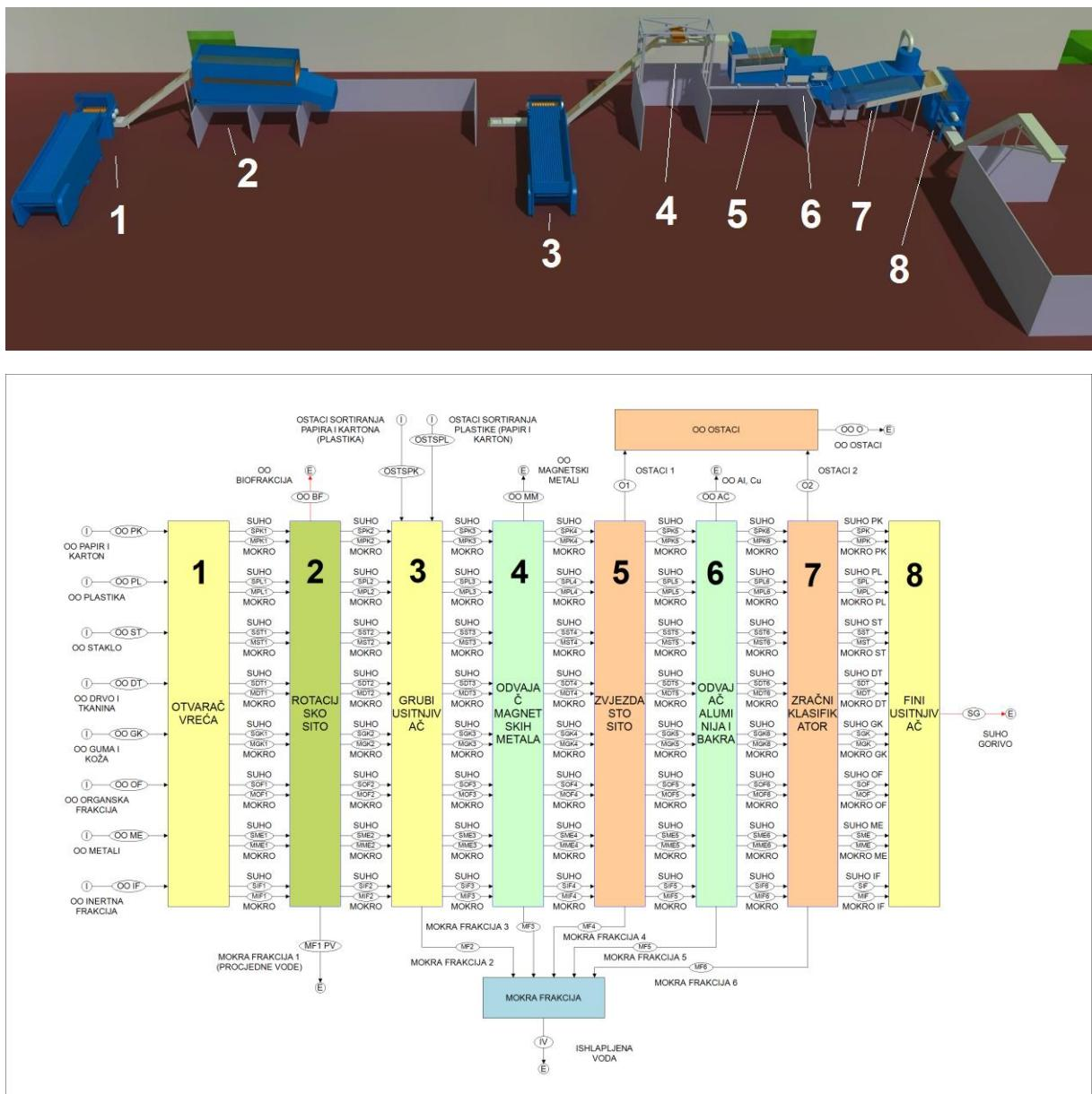
Slika 12. Modul za mehaničku obradu (gore) i blok shema modula (dolje).
