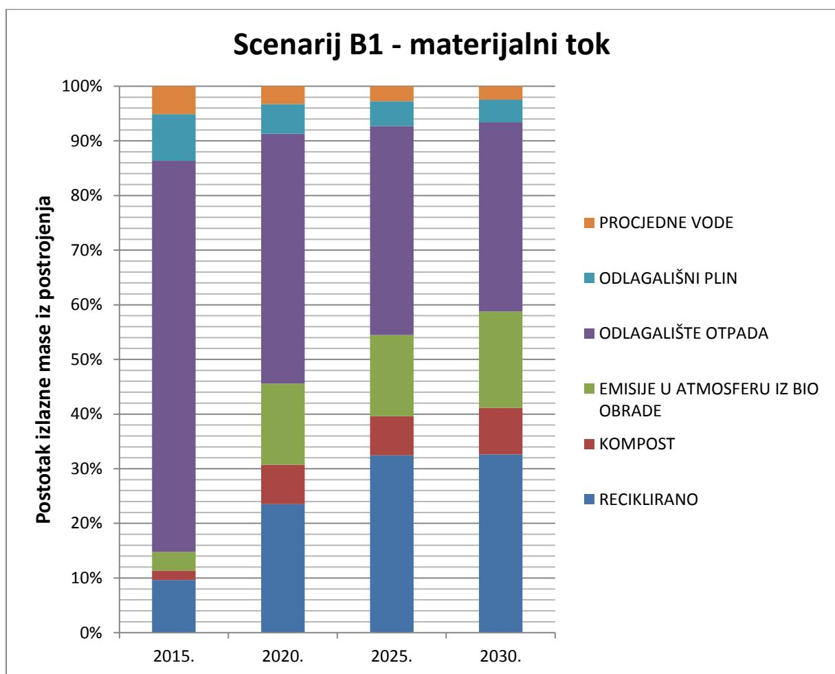
Slika 159. Postotni dijagram materijalnog toka u izlaznim proizvodima i na odlagalištu u scenariju B1 za stalni tok, pad toka i rast toka komunalnog otpada.
