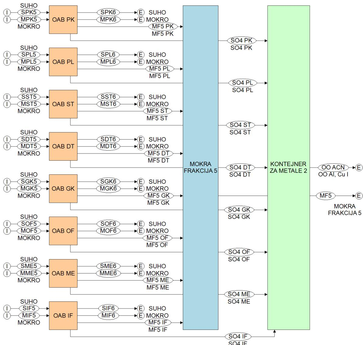
Slika 82. Blok shema podsustava odvajača aluminija i bakra.
