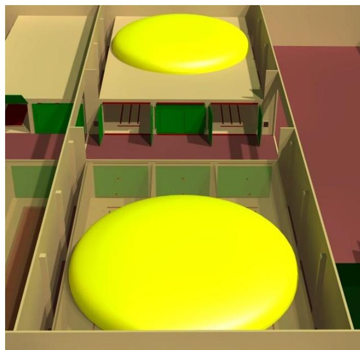
Slika 46. Anaerobni digestori.
