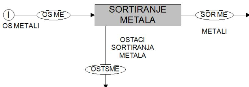
Slika 32. Blok shema sortiranja metala u scenariju B1.
