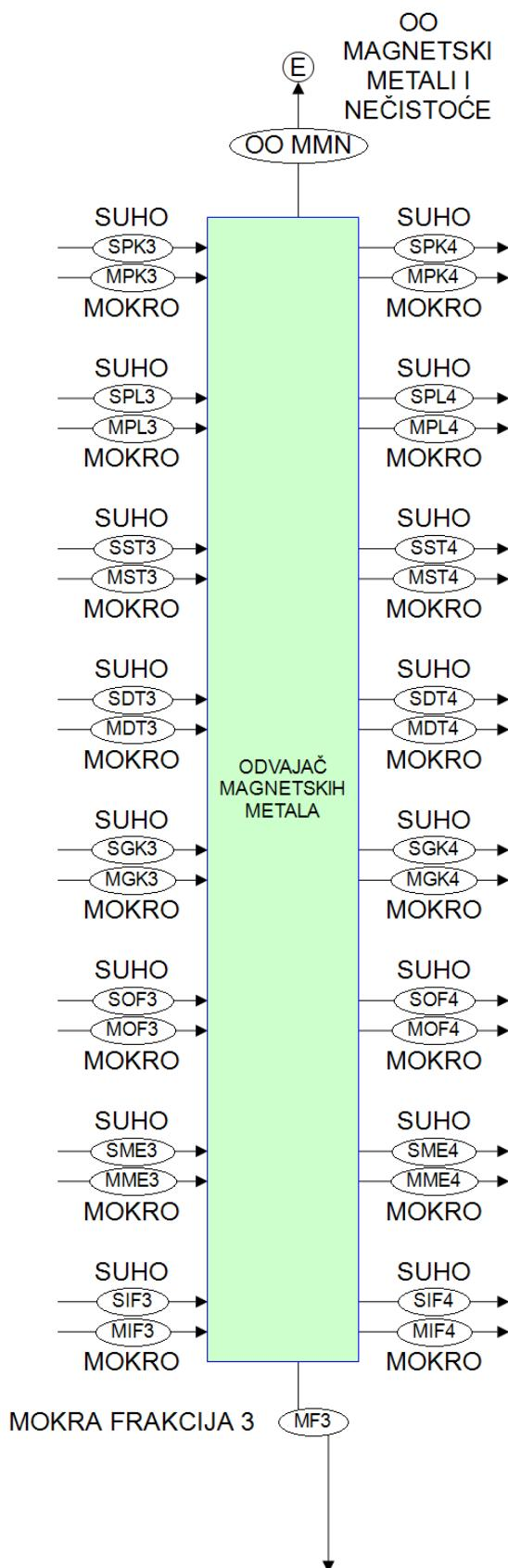
Slika 75. Blok shema sustava odvajača magnetskih metala.
