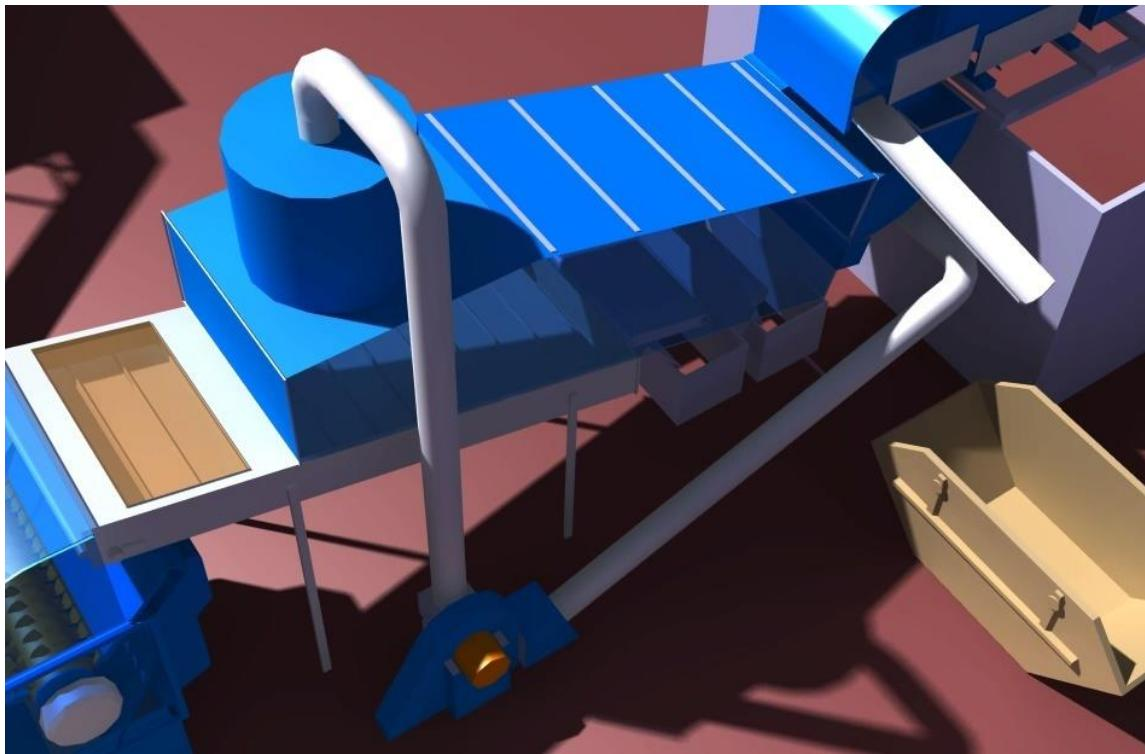
Slika 83. Zračni klasifikator.
