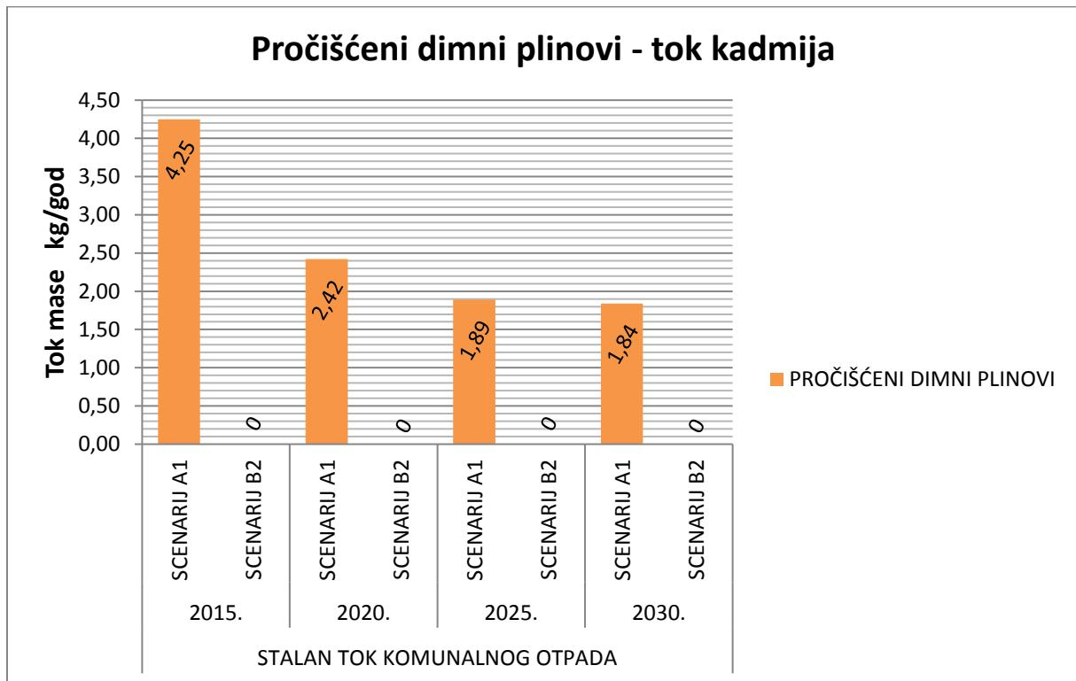
Slika 225. Dijagram usporedbi toka kadmija u pročišćenim dimnim plinovima u scenarijima A1 i B2 za stalni tok komunalnog otpada.
