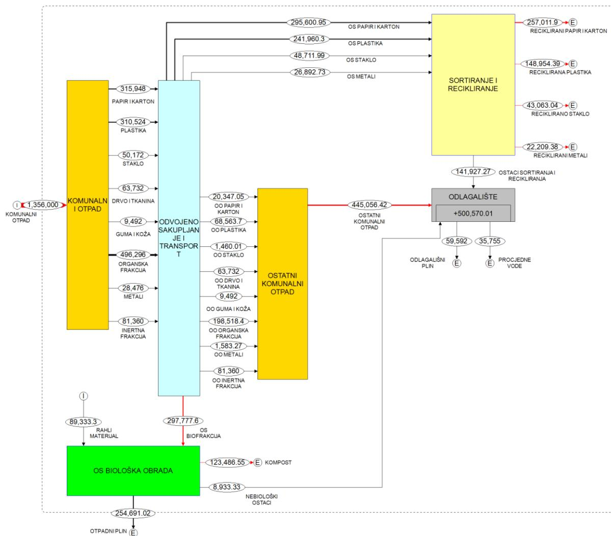
Slika P12. Scenarij B1, materijalni tok, stalni tok komunalnog otpada, 2030.
