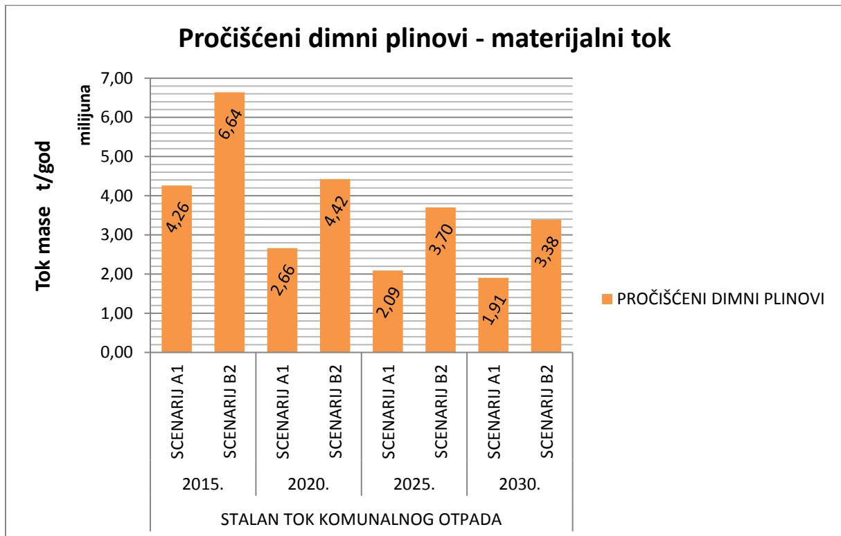
Slika 219. Dijagram usporedbe materijalnog toka u pročišćenim dimnim plinovima u scenarijima A1 i B2 za stalni tok komunalnog otpada.
