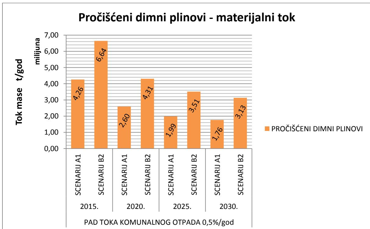
Slika 220. Dijagram usporedbe materijalnog toka u pročišćenim dimnim plinovima u scenarijima A1 i B2 za pad toka komunalnog otpada.
