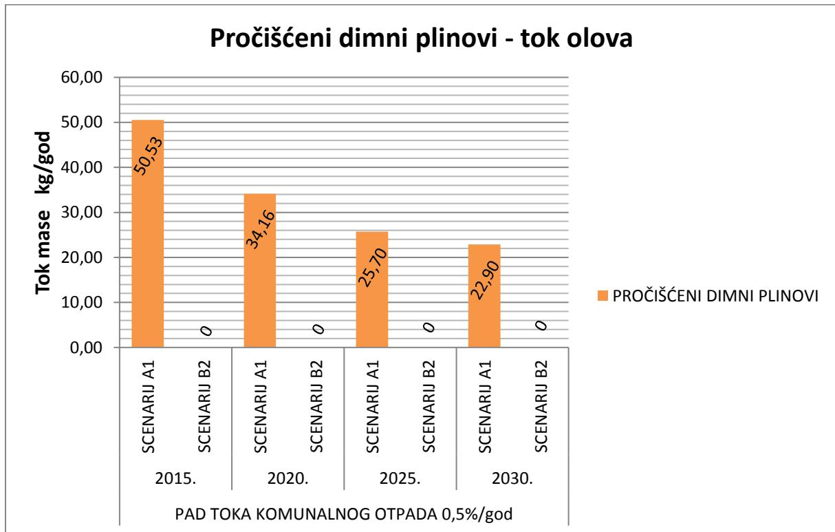
Slika 229. Dijagram usporedbe toka olova u pročišćenim dimnim plinovima u scenarijima A1 i B2 za pad toku komunalnog otpada.
