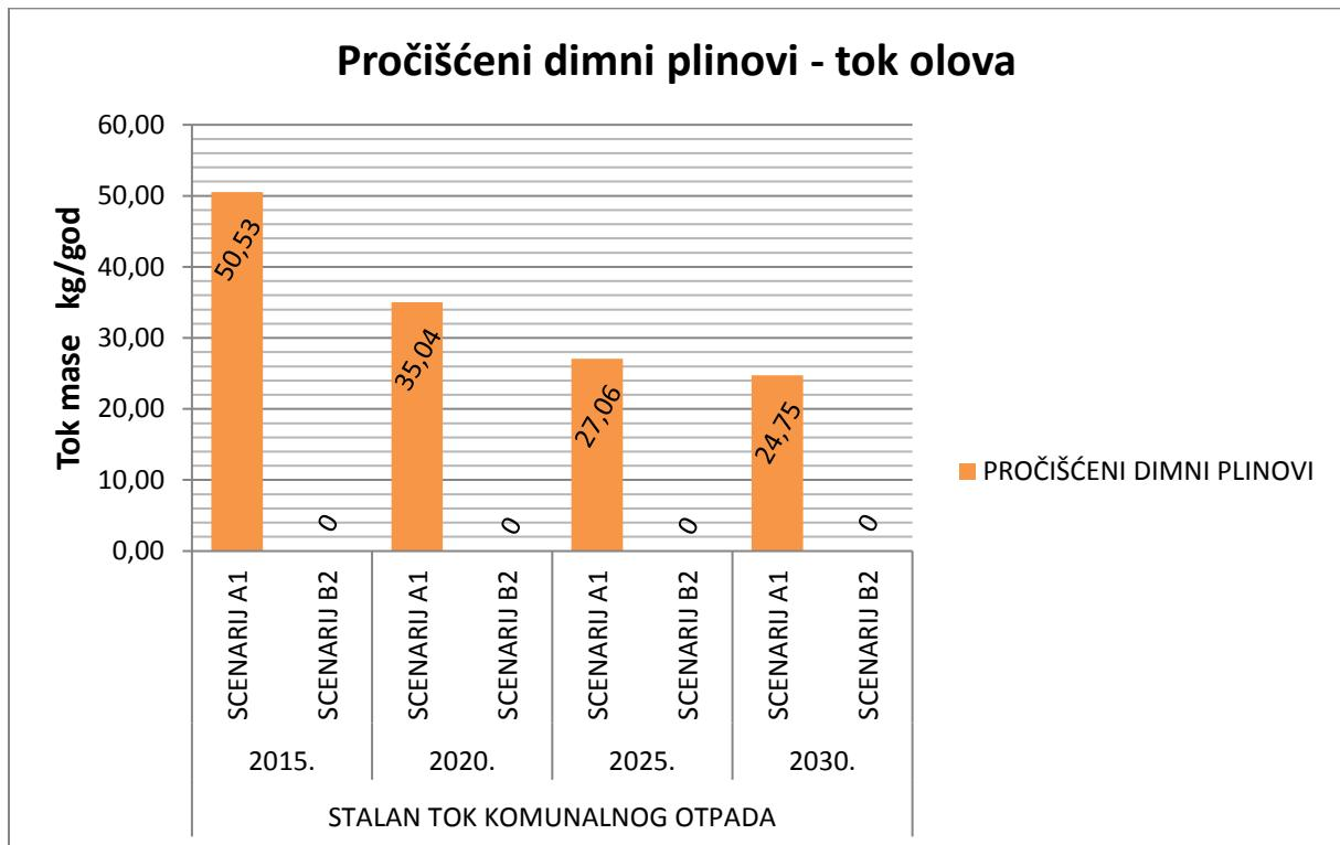
Slika 228. Dijagram usporedbe toka olova u pročišćenim dimnim plinovima u scenarijima A1 i B2 za stalni tok komunalnog otpada.
