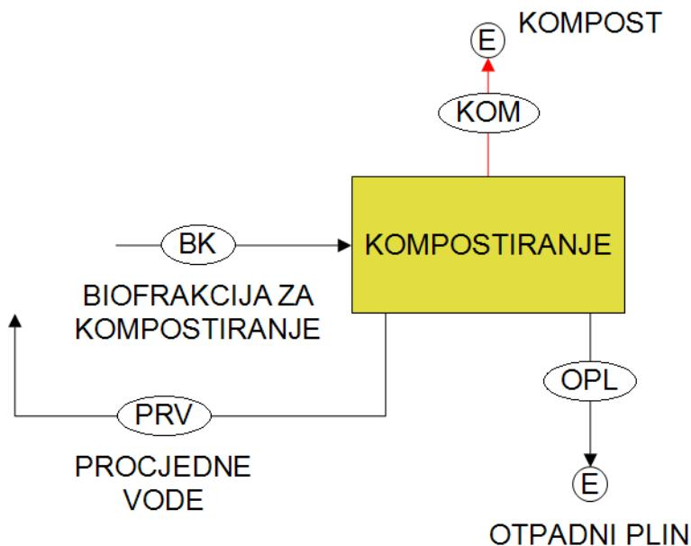
Slika 63. Blok shema izravnog kompostiranja odvojeno sakupljene biofrakcije [23].
