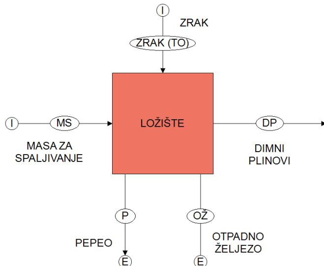
Slika 123. Blok shema ložišta za spaljivanje na rešetci [51].
