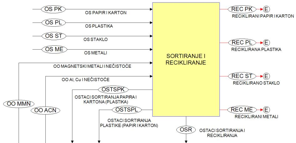
Slika 19. Blok shema sustava modula za sortiranje i recikliranje u scenarijima A1 i A2.
