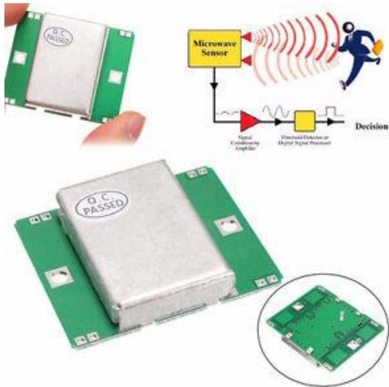
Slika 5. Predodžba mikrovalnog detektora [11]
