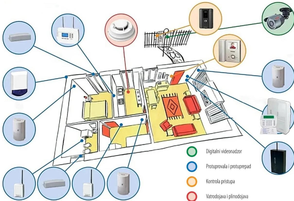
Slika 13. Predodžba 3D prikaza primjene tehničke zaštite luksuzne obiteljske kuće
