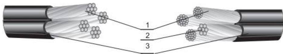
Slika 1. Konstrukcija SKS kabela
