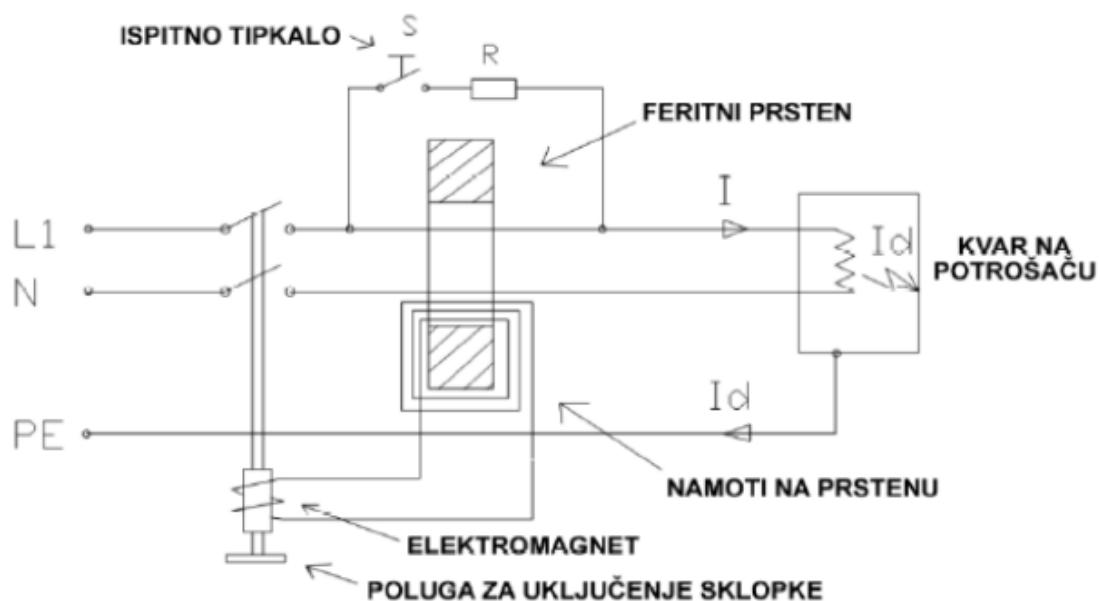
Slika 6. Princip rada FID sklopke
