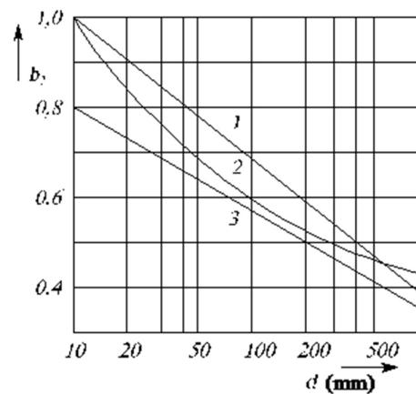
Slika 30. Faktor dimenzije strojnog dijela za promjenjiva naprezanja [24]
