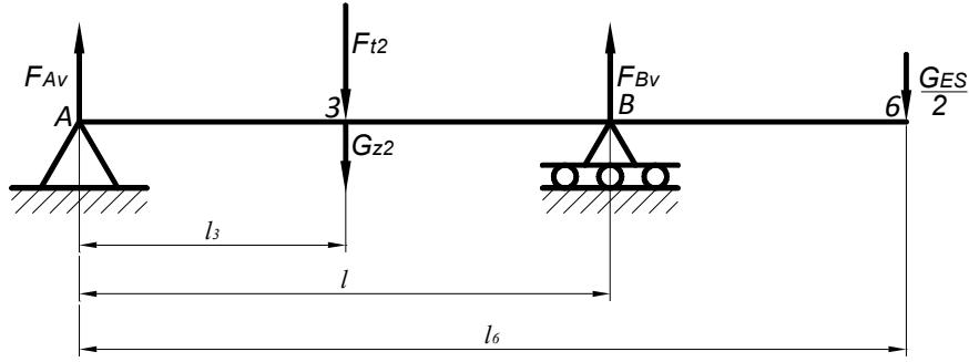
Slika 22. Sile na vratilu u vertikalnoj ravnini
