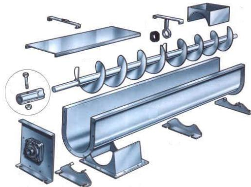
Slika 10. Vratilo pužnog vijka u procesnoj industriji [17]
