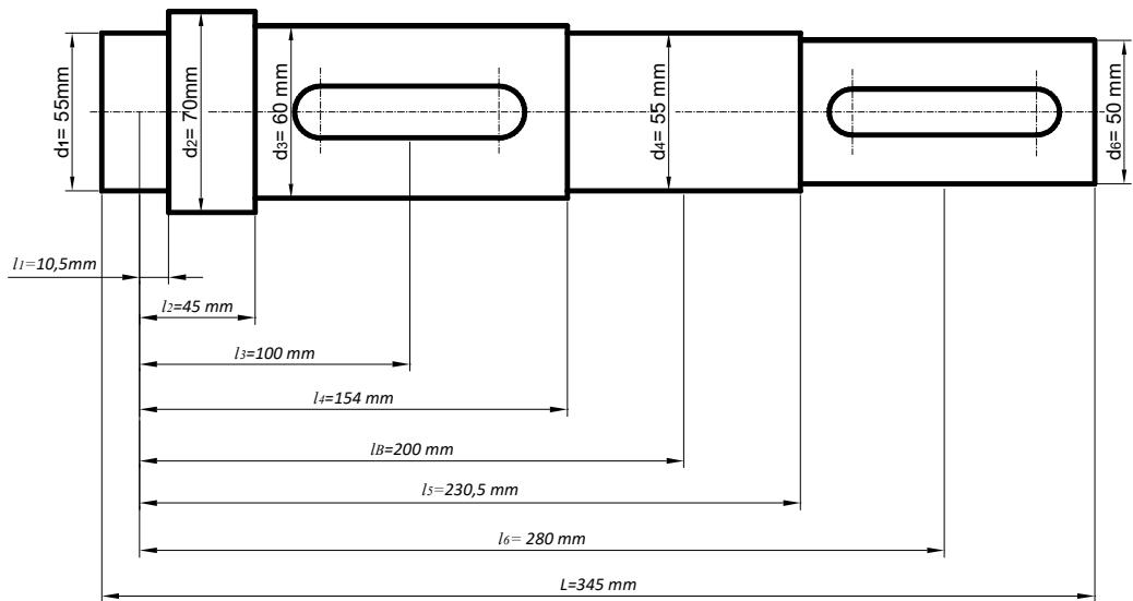
Slika 25. Konstrukcijske dužine i promjeri vratila u pojedinim presjecima
