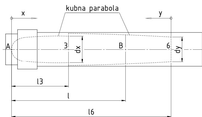
Slika 23. Projekcija idealnog vratila - oblik kubne parabole
