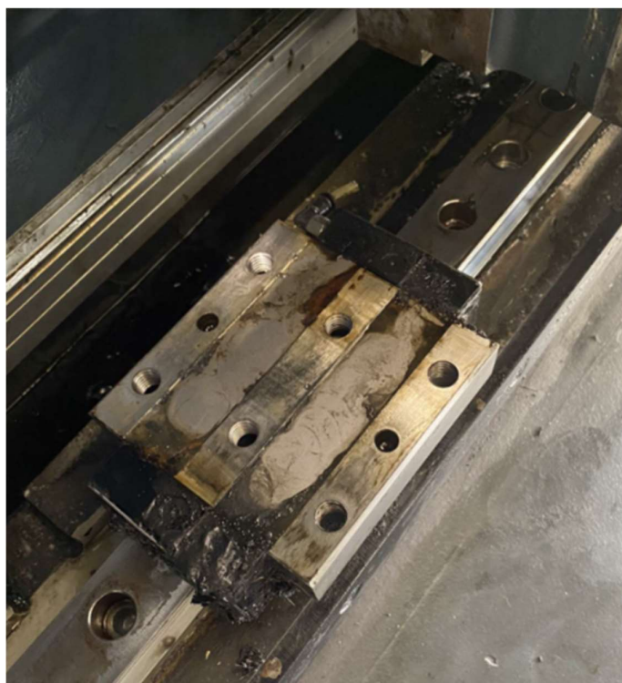
Slika 65. Odvojen pomični dio vodilice od radnog stroja
