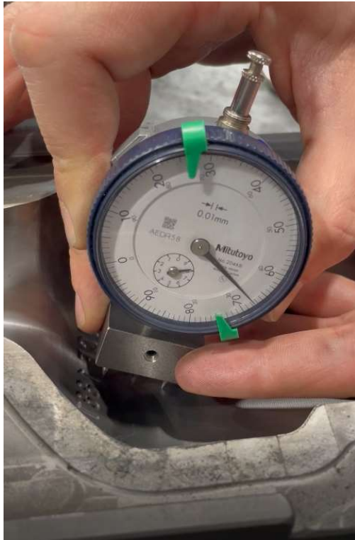
Slika 79. Dubina obrade u jednom zakretu
