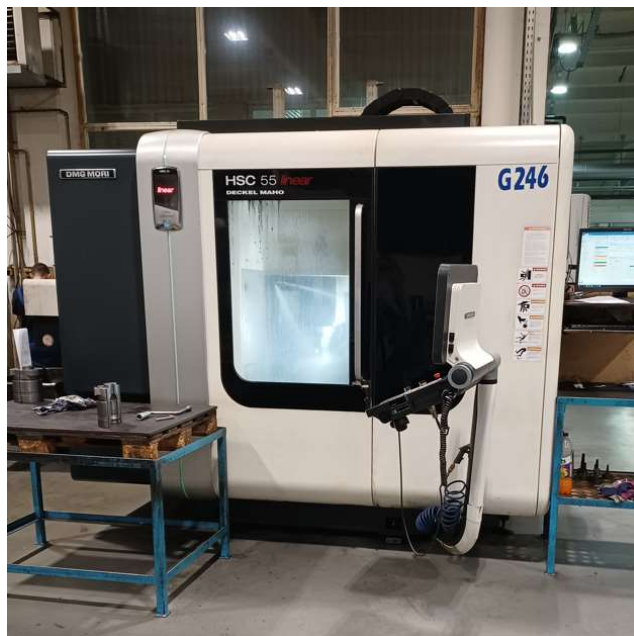
Slika 49. prikaz 5-osne glodalice HSC 55 linear
