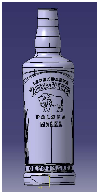
Slika 50. 3D model koji služi za kopiranje fazone
