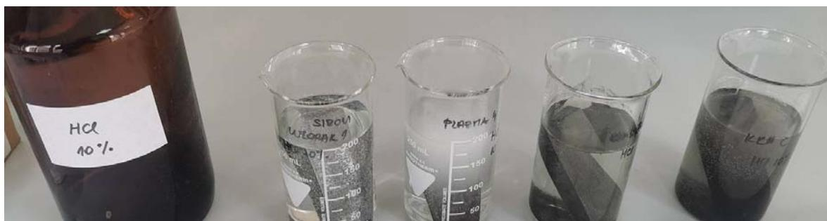
**Slika 23.** Uzorci čelika u 10% klorovodičnoj kiselini.
