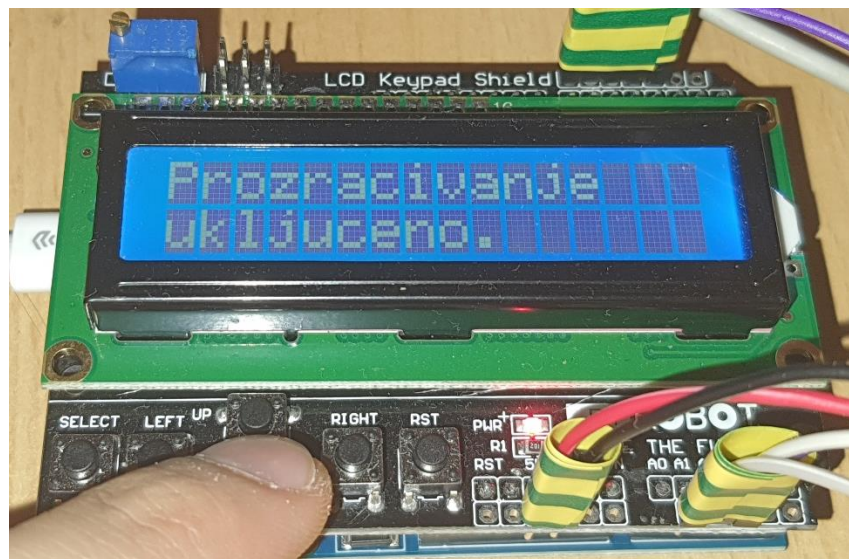
Slika 51. Predodžba manualnog pokretanja funkcije prozračivanja
