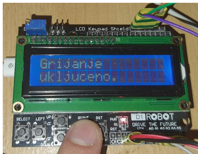
Slika 45. Predodžba manualnog pokretanja funkcije grijanja
