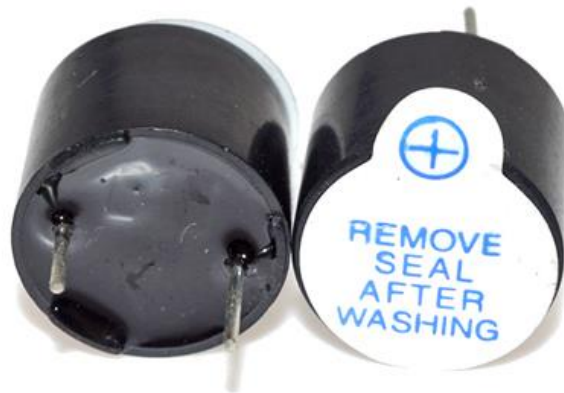
Slika 15. Predodžba aktivne zujalice [28]
