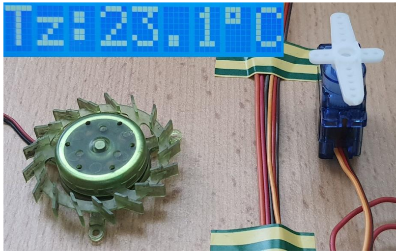
Slika 36. Predodžba testiranja sustava prozračivanja (isključeno)
