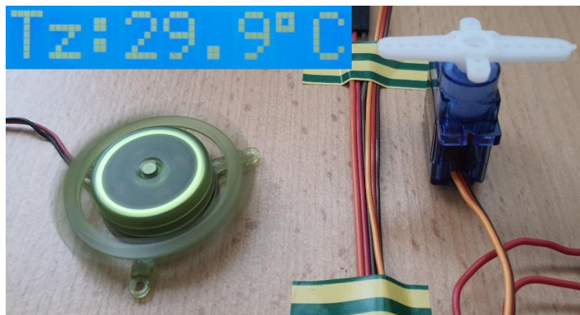
Slika 37. Predodžba testiranja sustava prozračivanja (uključeno)
