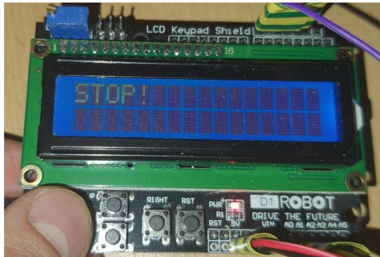
Slika 54. Predodžba manualnog isključivanja svih izvršnih funkcija
