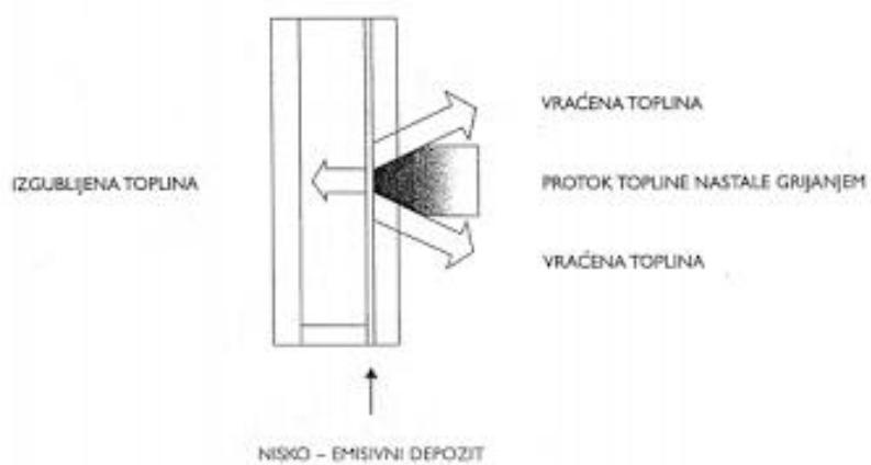
*Princip djelovanja niskoemisionog nanosa na stakla*
