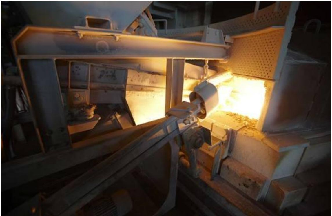
Slika 1. Peć za topljenje stakla
