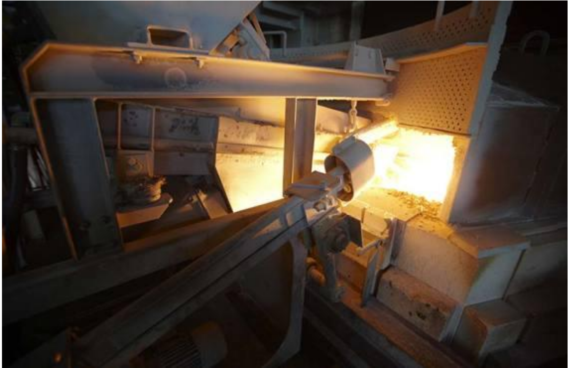
Slika 1. Peć za topljenje stakla
