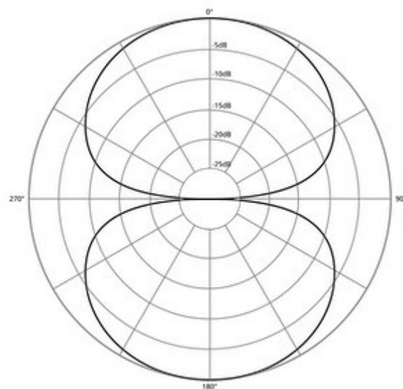
Slika 10. Predodžba polarnog uzorka dvosmjernog mikrofona [16].
