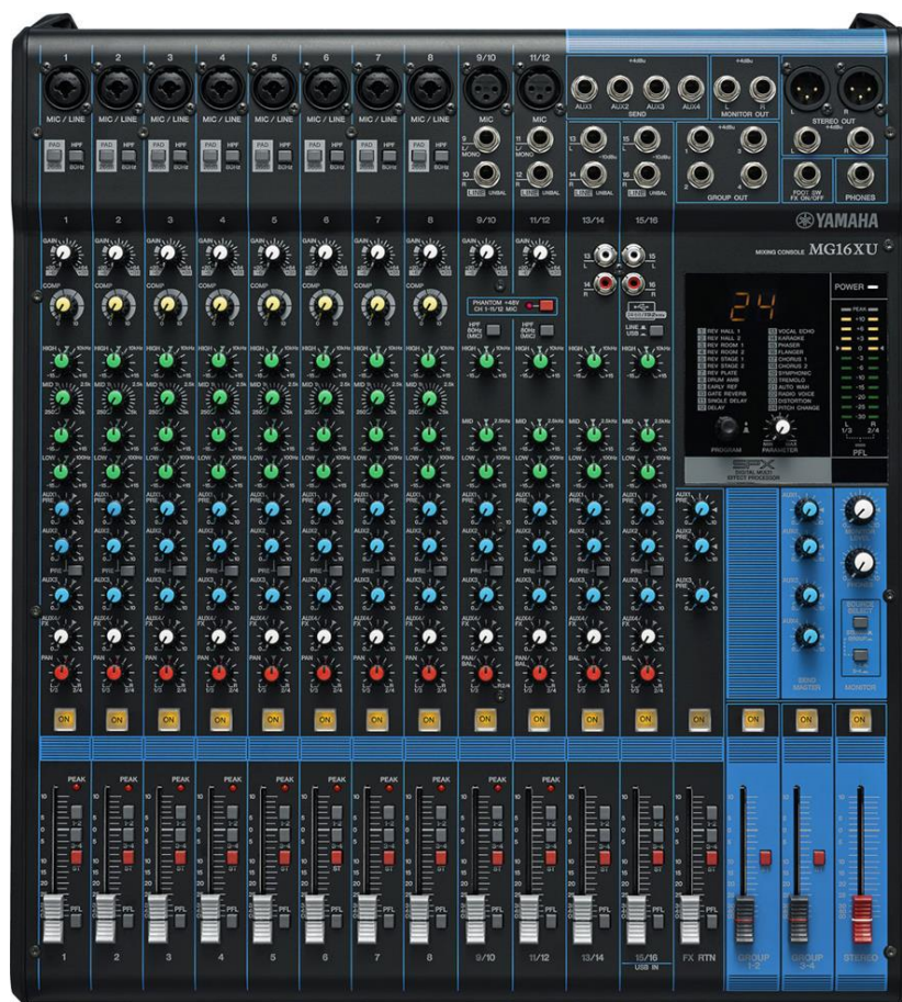
Slika 12. Predodžba analogne miksete proizvođača Yamaha model MG16XU [20].
