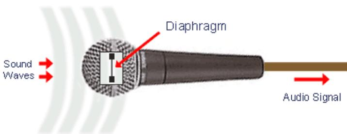
Slika 4. Predodžba pozicije membrane u mikrofonu [7].
