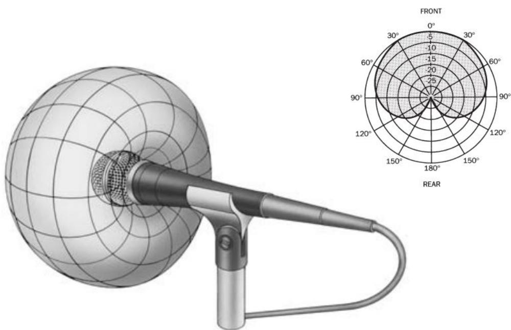
Slika 8. Predodžba polarnog uzorka kardioidnog mikrofona [14].
