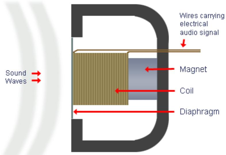
Slika 5. Predodžba poprečnog presjeka dinamičkog mikrofona [10].
