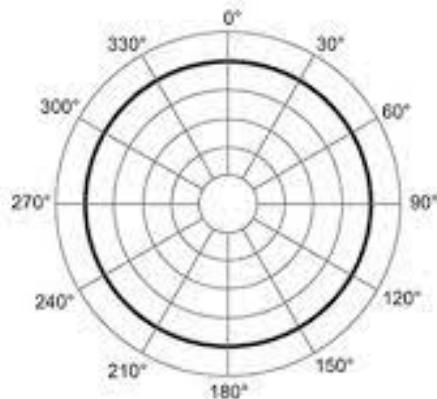
Slika 7. Predodžba polarnog uzorka višesmjernog mikrofona [13].
