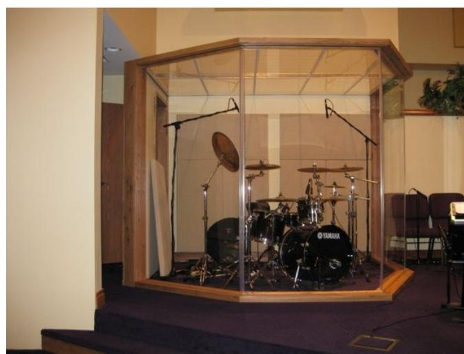
Slika 15. Predodžba izolacijske kabine bubenjeva [25].
