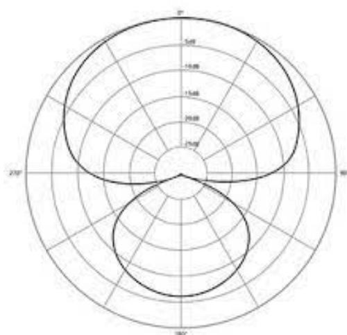
Slika 9. Predodžba polarnog uzorka hiperkardioidnog mikrofona [15].
