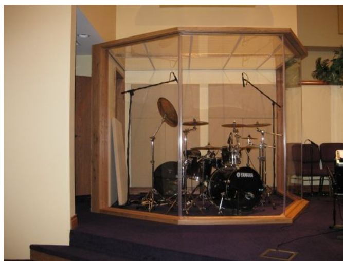
Slika 15. Predodžba izolacijske kabine bubnjeva [25].
