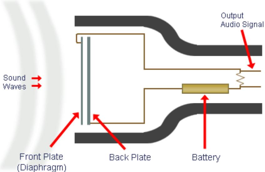
Slika 6. Predodžba poprečnog presjeka kondenzatorskog mikrofona [11].
