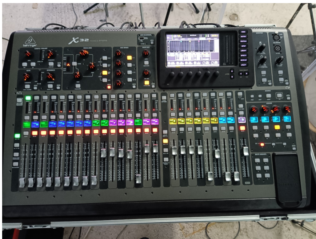
Slika 13. Predodžba digitalne miksete proizvođača Behringer model X32.
