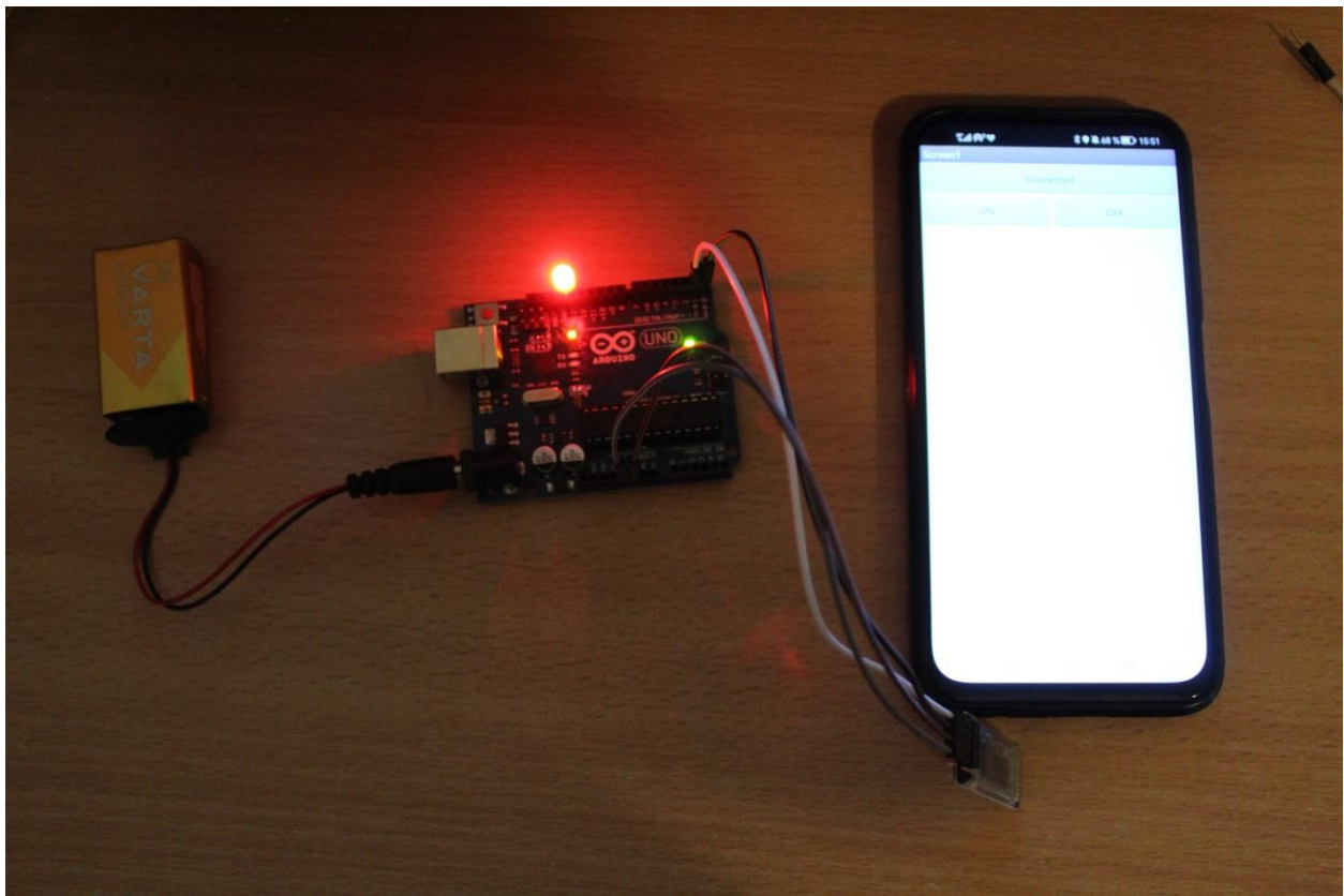
Slika 18. Predodžba mikro upravljača koji ima naredbu "ON" na aplikaciji.
