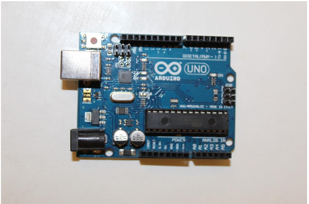
Slika 2. Predložba mikro upravljača Arduino UNO.
