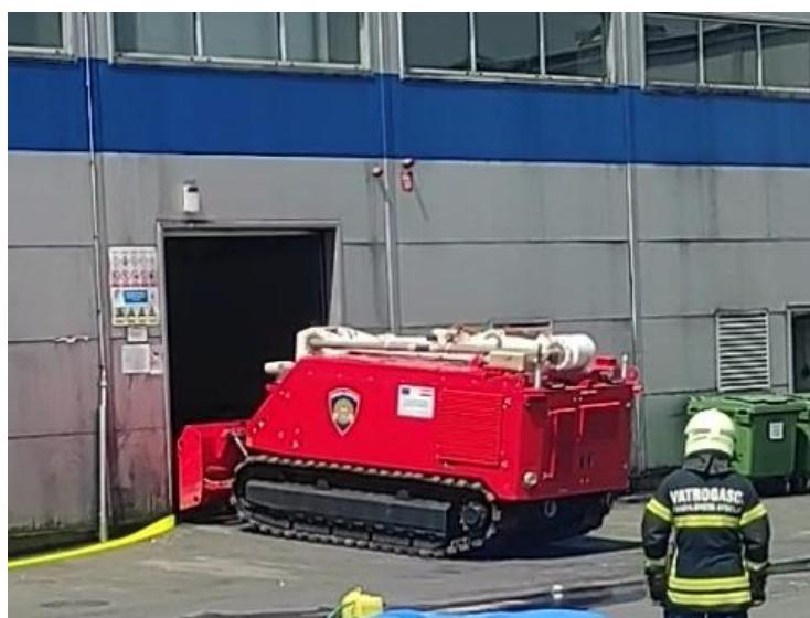
Slika 5. Specijalno vozilo MVF-5 [5]
