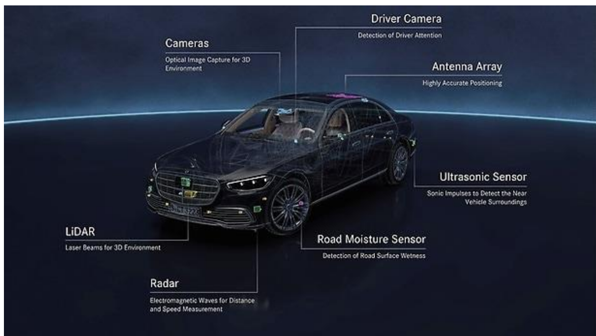
Slika 10. Senzori DrivePilot-a, Mercedes Benz S klasa, izvor [46]
