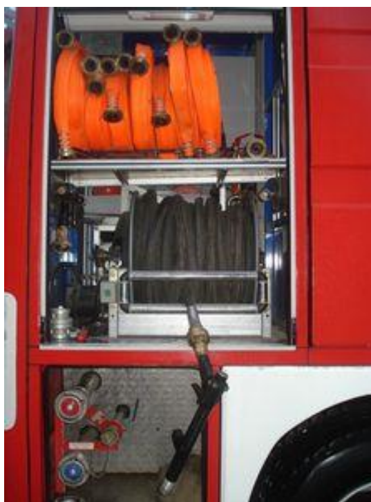
Sl.18. Ugrađena oprema na vozilu za visoki tlak
