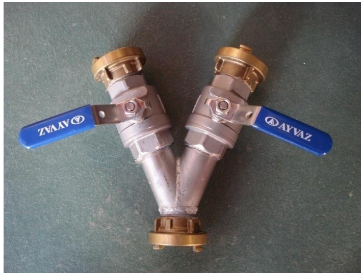
Sl.21. Dvodijelna razdjelnica visokog tlaka sa ventilima PN, 63 bara
