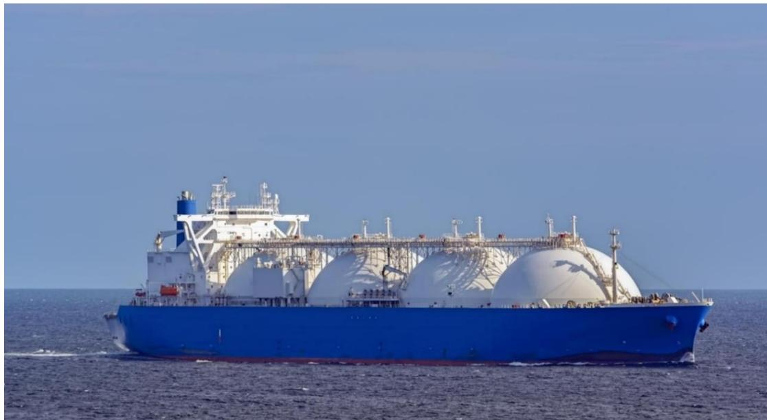
Slika 5. Tanker sa kuglastim spremnikom za prijevoz plina [9]
