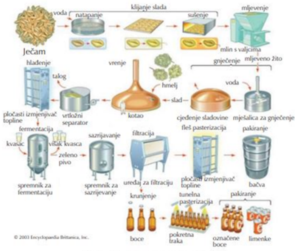
Slika 1. Prikaz toka procesa proizvodnje piva (Matijašević, 2023)
