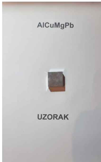
Slika 14. Označeni uzorak AlCuMgPb legure nakon ispitivanja na tvrdomjeru
