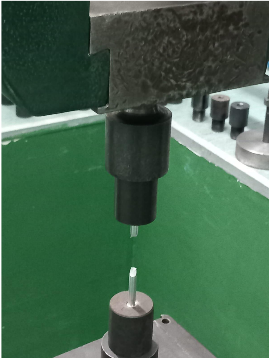
Slika 9. Položaj puknuća epruvete u kidalici
