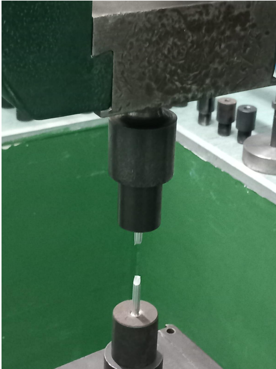
Slika 9. Položaj puknuća epruvete u kidalici
