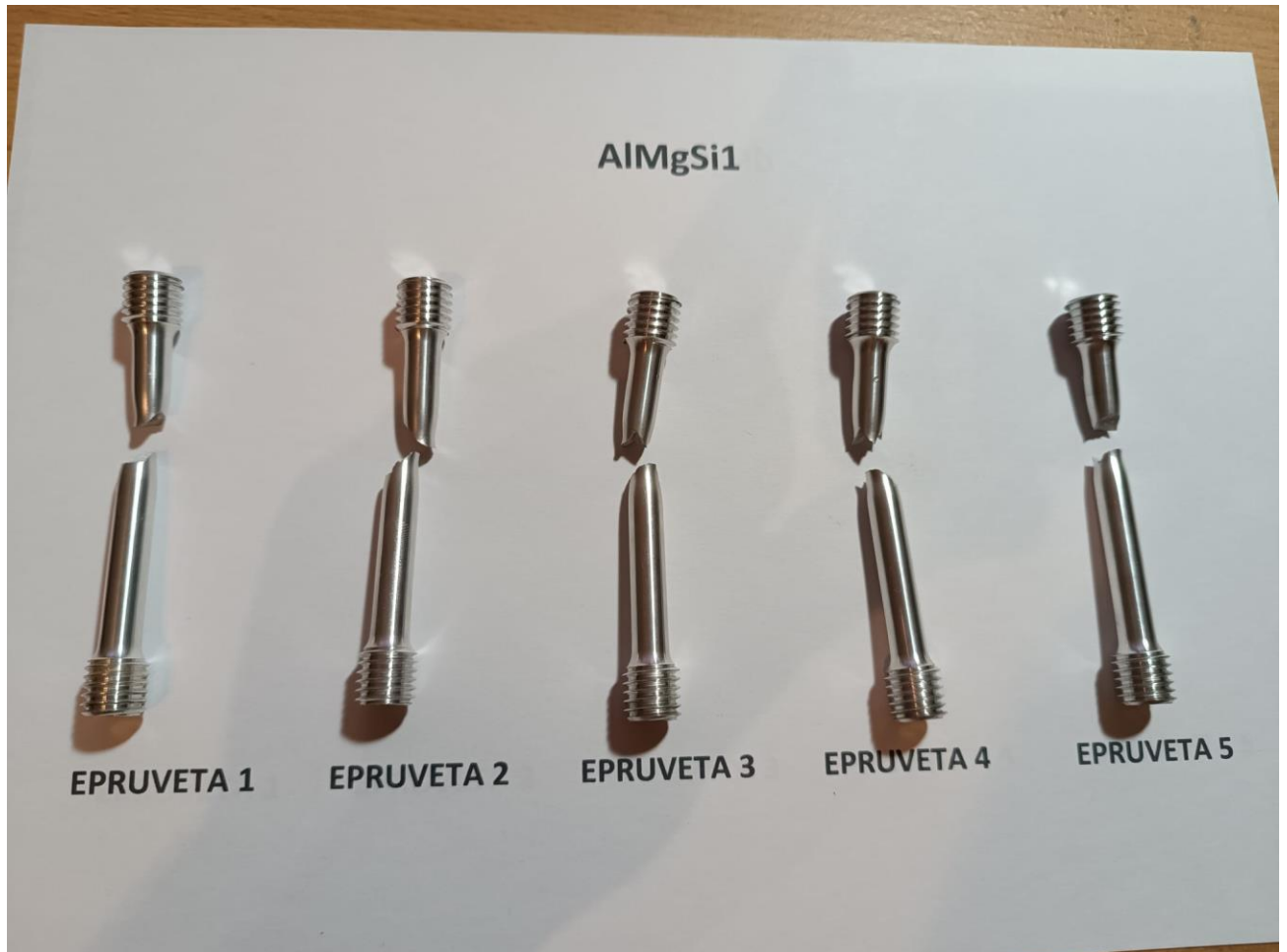
Slika 10. Epruvete legure AlMgSi1 nakon ispitivanja
