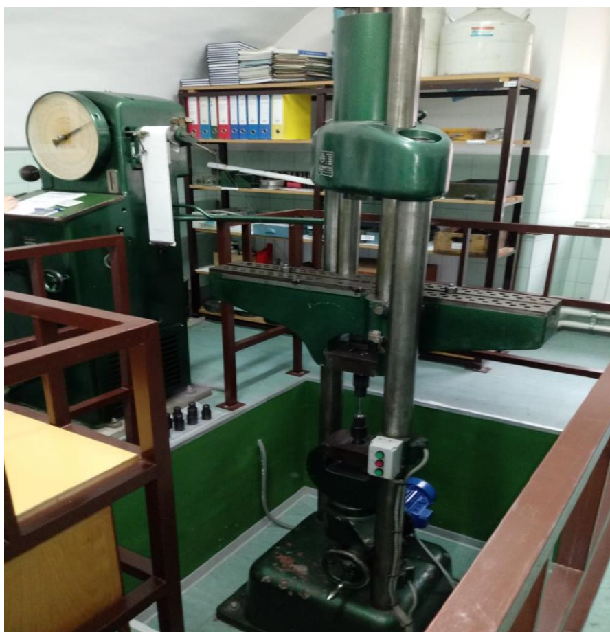
Slika 5. Kidalica u laboratoriju za ispitivanje materijala Veleučilišta u Karlovcu
