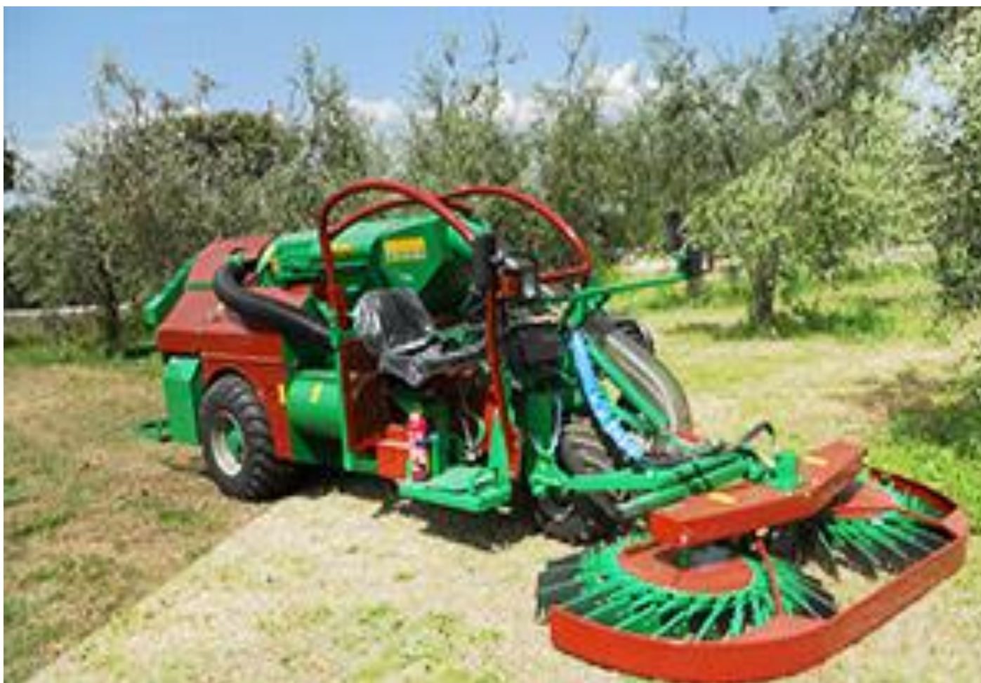
Slika 15 Kombajn za lješnjake [5]
