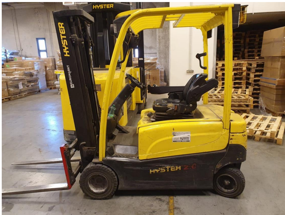
Sl. 20. Prikaz čeonog viličara [Vlastita fotografija]
