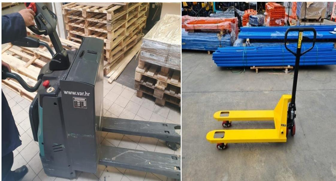
Sl. 22. Prikaz ručnog el. viličara (slika lijevo) i
