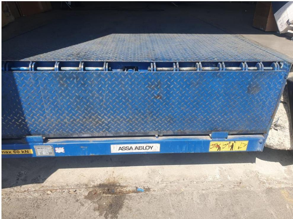
Sl. 26. Prikaz hidrauličke pretovarne rampe [Vlastita fotografija]
