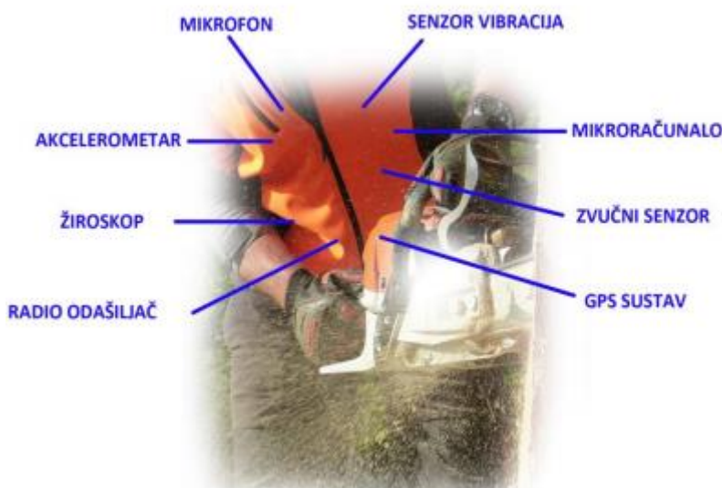
Slika 6. Inteligentna jakna za nadzor rada šumskih radnika [12]
