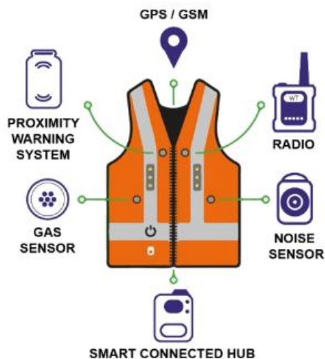
Slika 9. Zaštitni prsluk sa senzorima [16]
