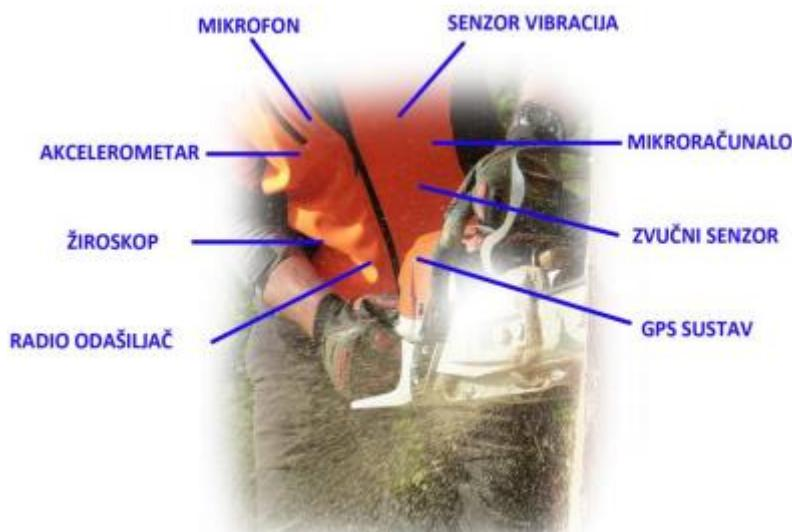
Slika 6. Inteligentna jakna za nadzor rada šumskih radnika [12]
