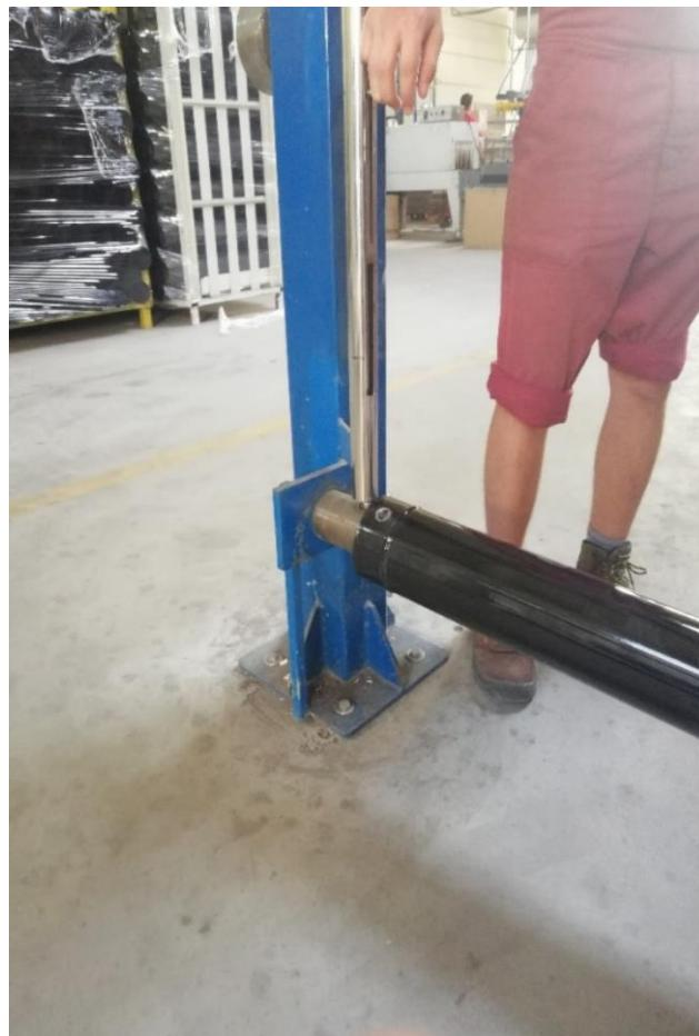
Slika 18. Postupak ispitivanja prionjivosti emajla [11]
