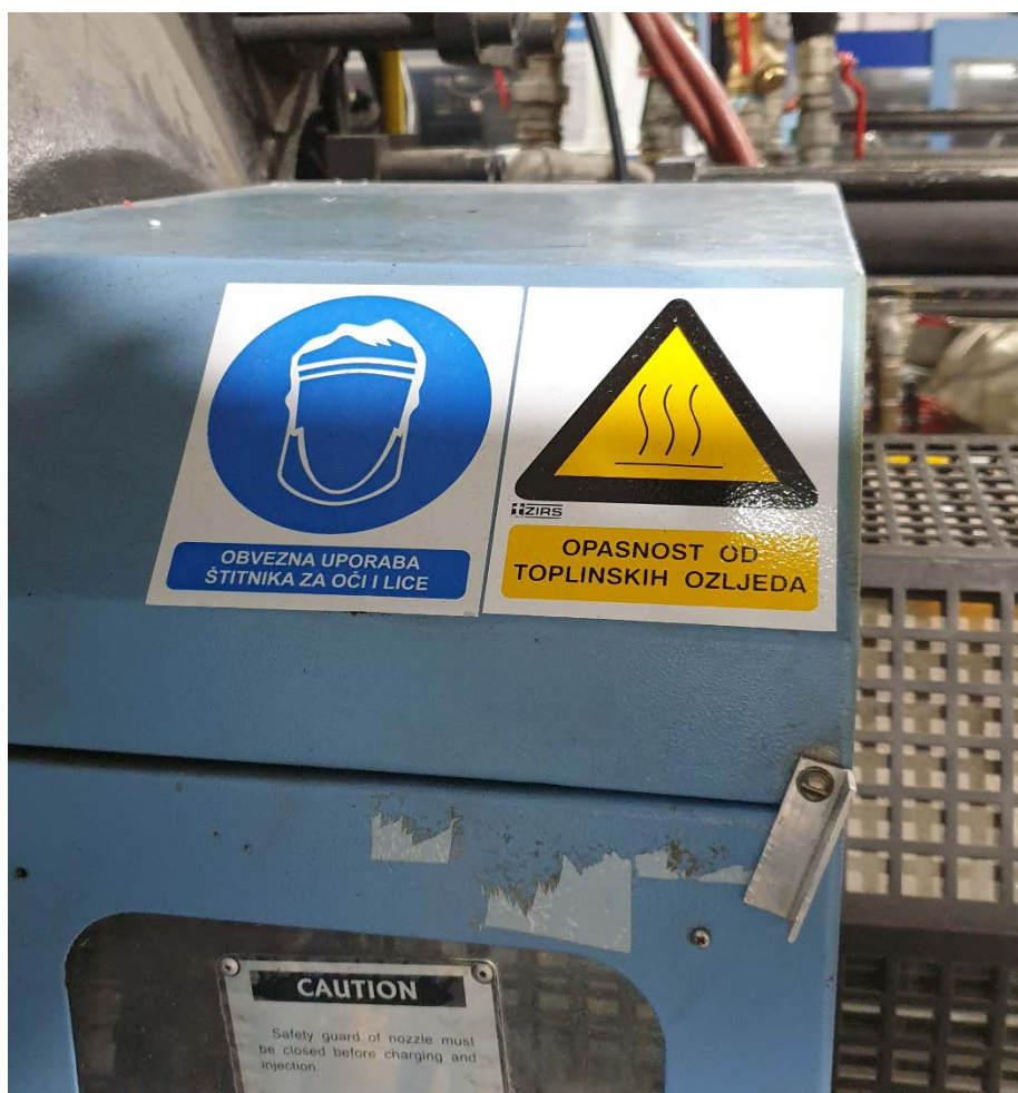
Slika 13. Znakovi upozorenja na stroju za injekcijsko prešanje
