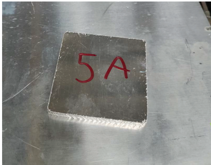
slika 46.: Na petom obratku nema srha
