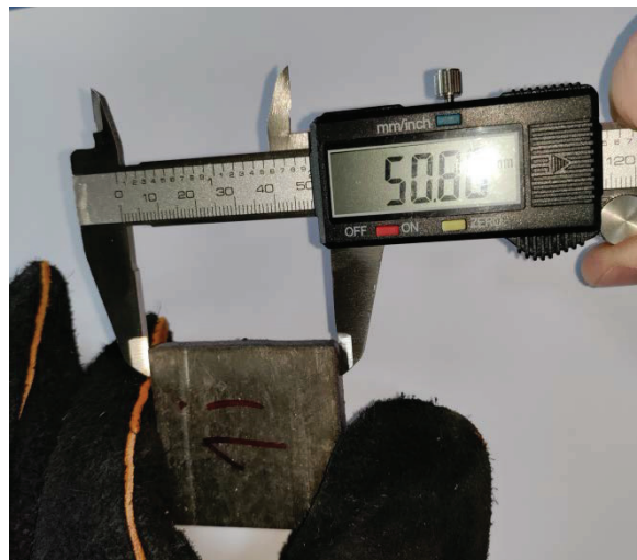
Slika 31.: Provjera prve dimenzije na obratku
