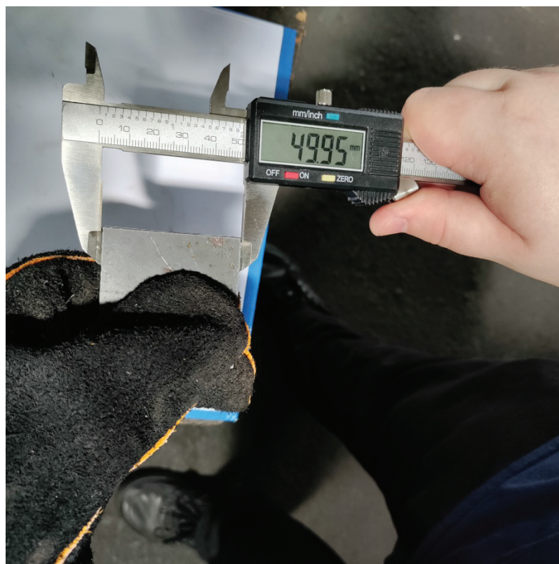
Slika 26.: Mjerenje druge dimenzije pomičnim mjerilom
