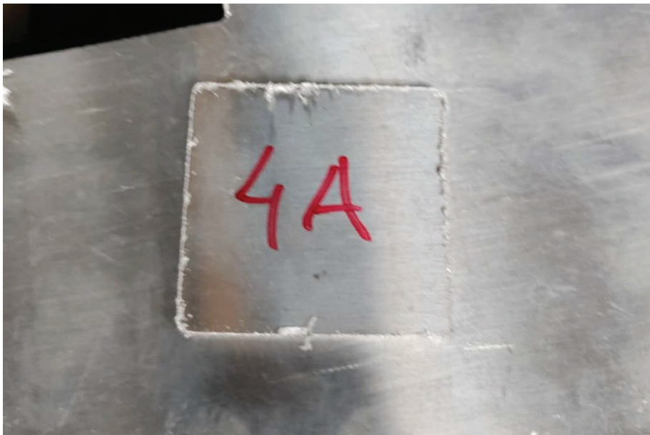
Slika 44.: Poleđina četvrtog obradka na kojoj ima srh
