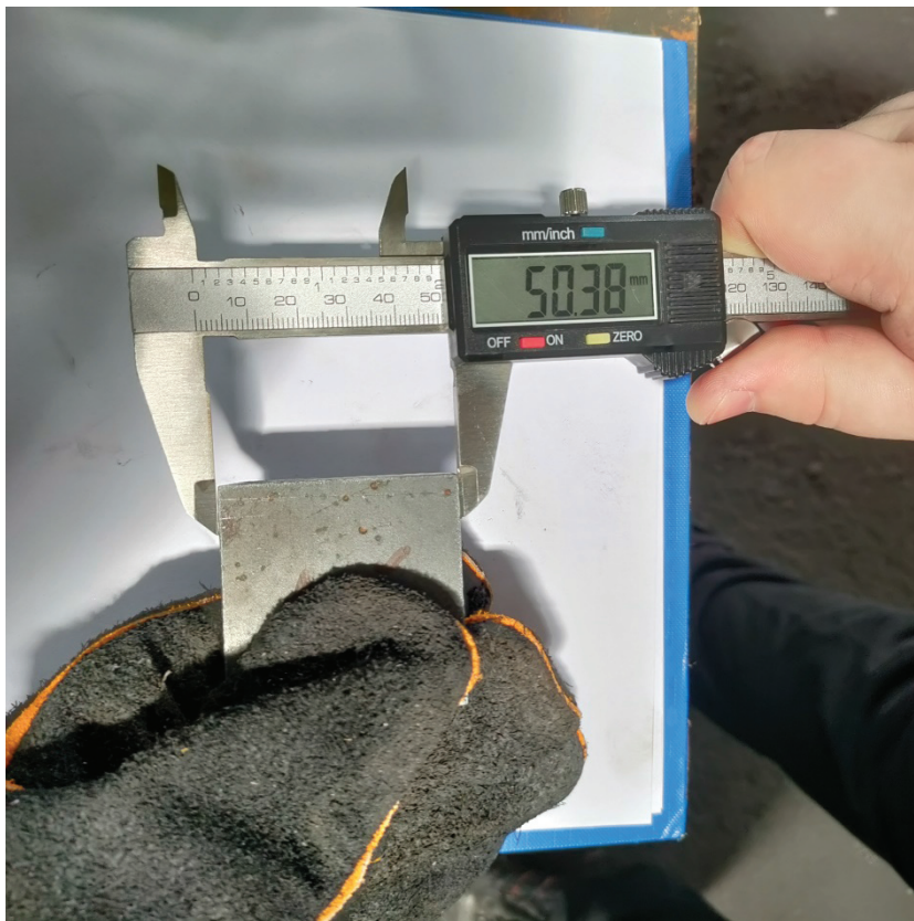
Slika 25.: Mjerenje prve dimenzije uz pomoć pomičnog mjerila
