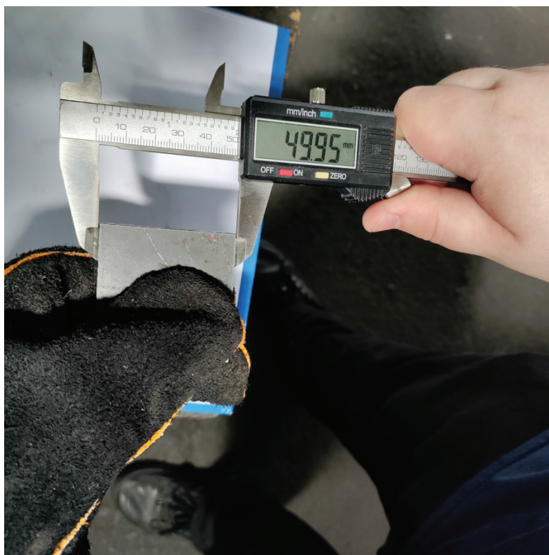
Slika 26.: Mjerenje druge dimenzije pomičnim mjerilom
