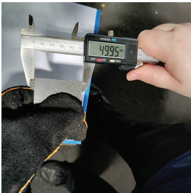
Slika 26.: Mjerenje druge dimenzije pomičnim mjerilom
