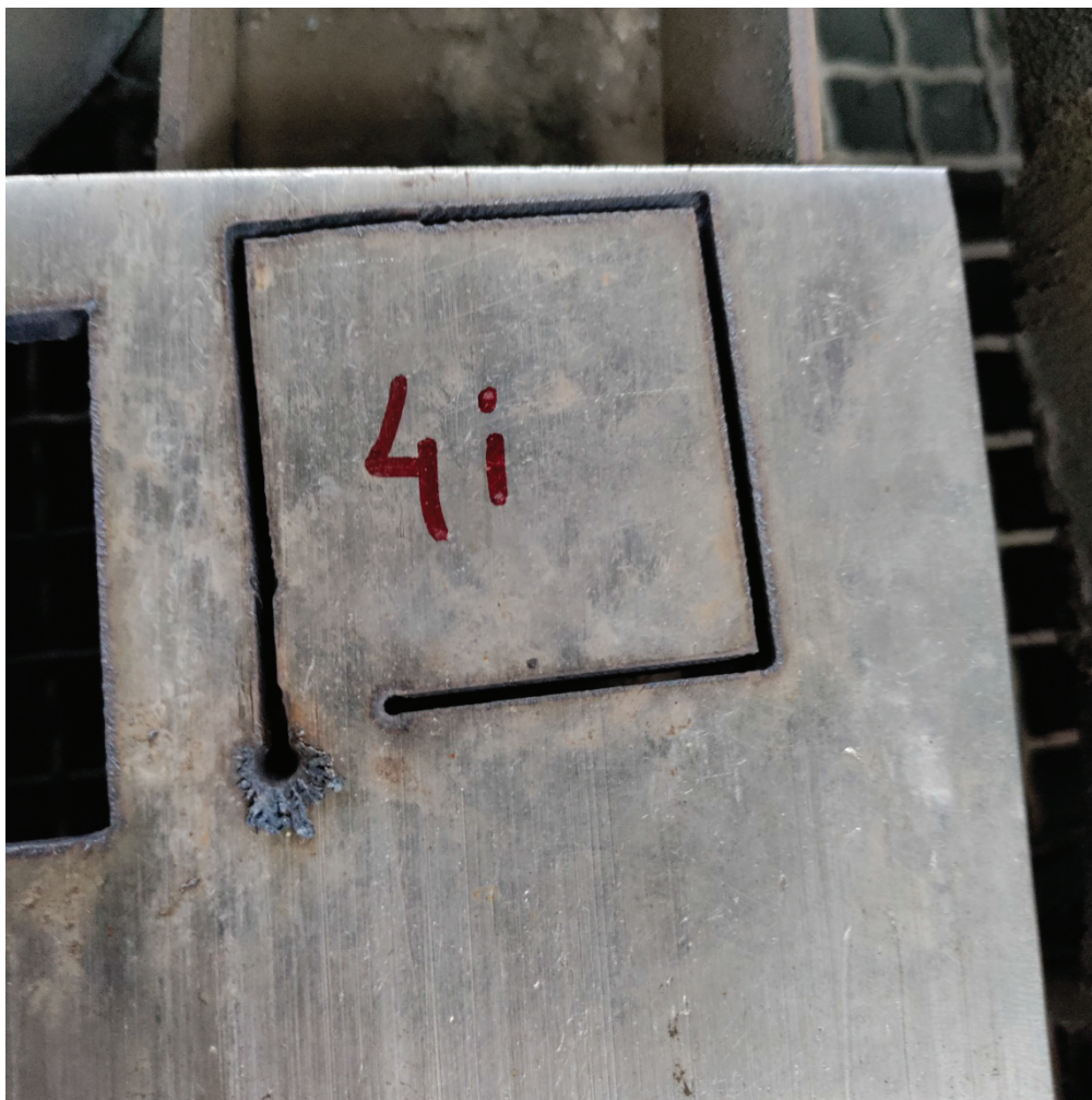
Slika 35.: Četvrti rez nije uspio
