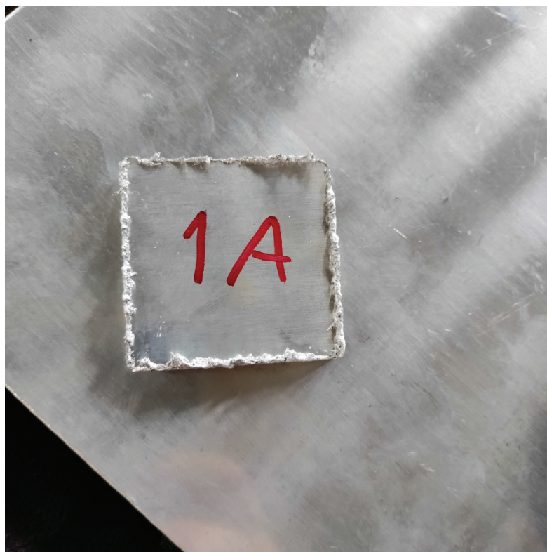
Slika 38.: Prvi izrezani obradak iz aluminijskog lima
