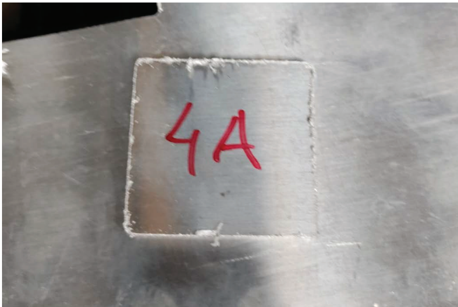
Slika 44.: Poleđina četvrtog obradka na kojoj ima srh
