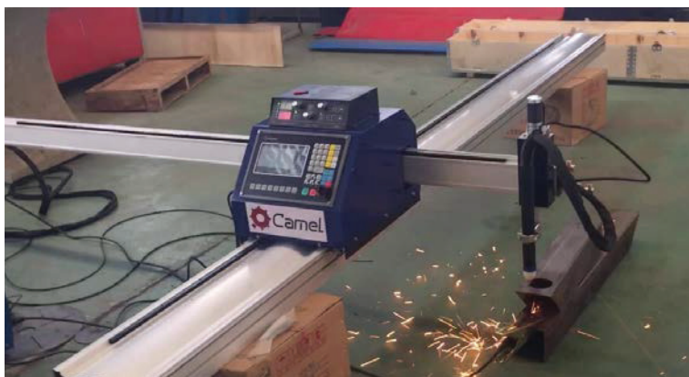
Slika 10.: Rezanje sa prijenosnom CNC plazmom
