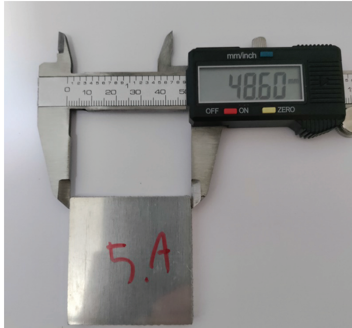
Slika 47.: Mjerenje prve dimenzije na petom obratku
