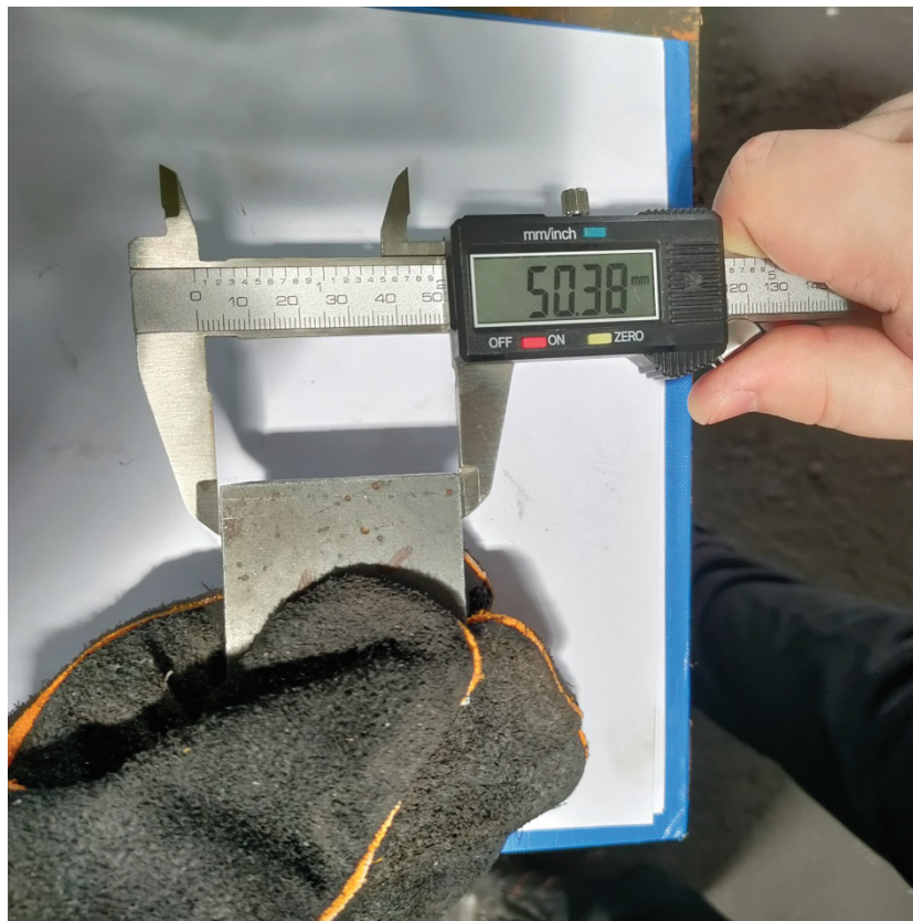
Slika 25.: Mjerenje prve dimenzije uz pomoć pomičnog mjerila
