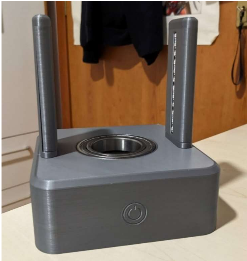
Slika 43 Montirani LED stupovi [8]
