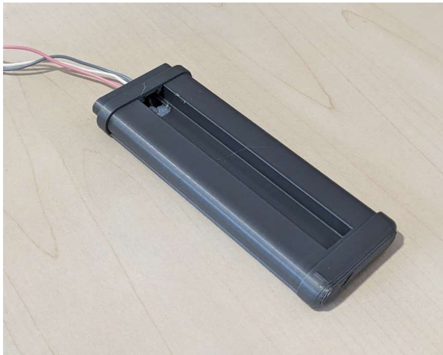
Slika 36 Tijelo stupa sa H senzorom [8]
