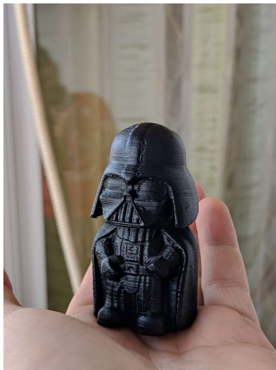
Slika 8 Figura Ispisana FDM tehnologijom [8]
