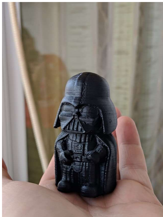
Slika 8 Figura Ispisana FDM tehnologijom [8]
