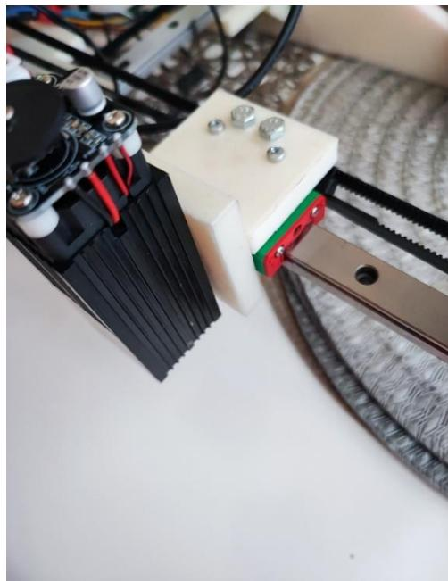
*Slika 18. Spoj Lasera sa nosačem*
