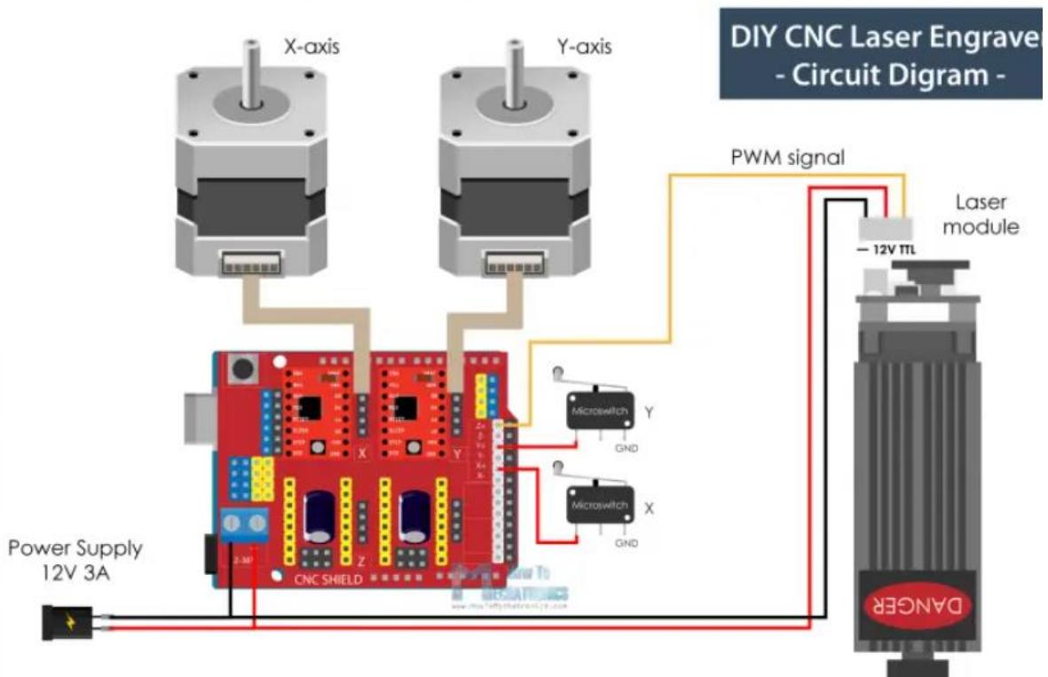
Slika 19. Shematski prikaz strujnog kruga CNC-a za graviranje [16]
