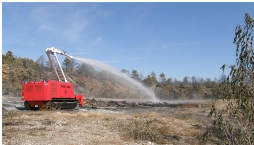
Slika 22. Samohodno gusjenično vozilo DOK-ING MVF-5[8]
