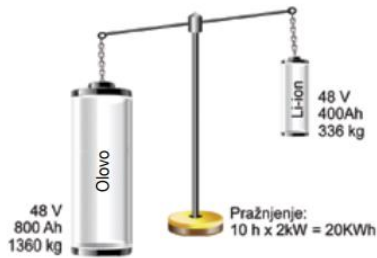
Slika 19. Olovna baterija u usporedbi s li-ion baterijom pri pražnjenju od 20 kWh [11]
