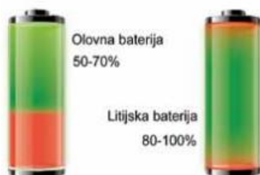
Slika 18. Iskoristivost energije iz olovnih i litij-ionskih baterija [20]
