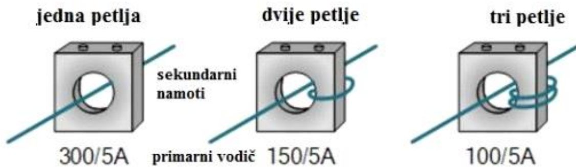
Slika 3. Namatanje dodatnih zavoja na sekundar [4]
