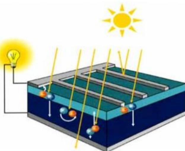
Slika 8. Nastanak parova elektron-šupljina u solarnoj ćeliji
