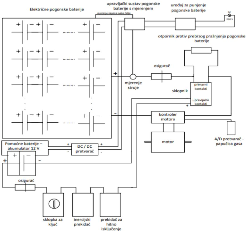
Slika 12. Blok shema elemenata vozila na električni pogon
