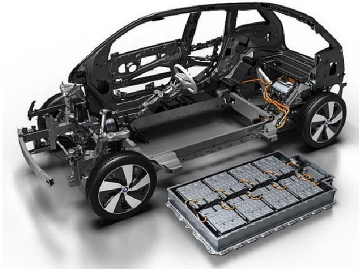
Slika 11. Baterija u električnom automobilu
