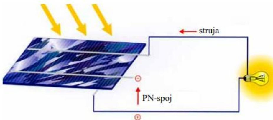
Slika 9. Solarna ćelija kao izvor električne energije
