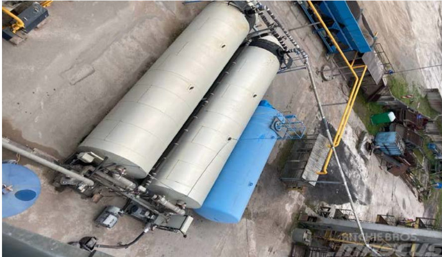
Slika 14. Bitumen-primjer skladištenja sirovina
